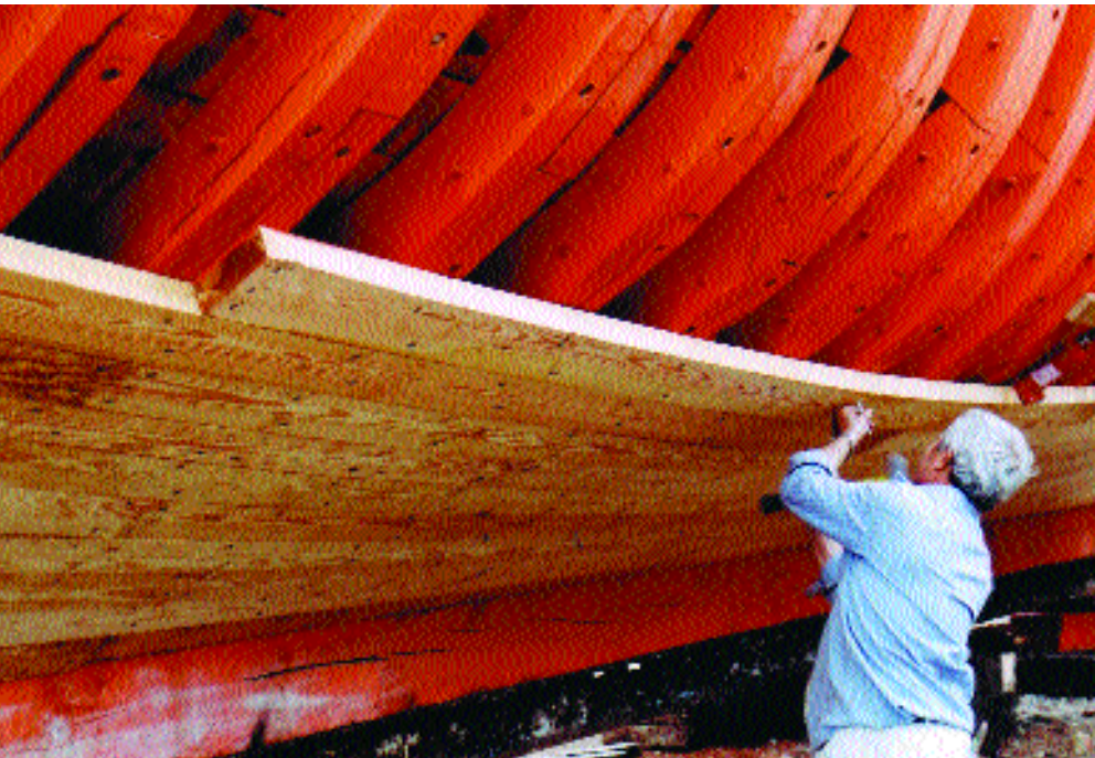
Κάρφωμα του πετσώματος στο ιστιοφόρο σκάφος "Κίρκη"
