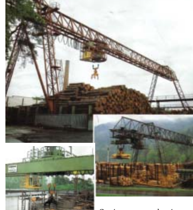
Οργάνωση κορμπολατείας με γεραμούς και αποθήκευση κορμών σε δεξαμενές.
