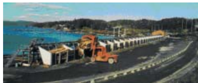
Αποθήκευση κορμών σε λίμνη και ταξινόμηση κορμών στην κορμπολατεία.
