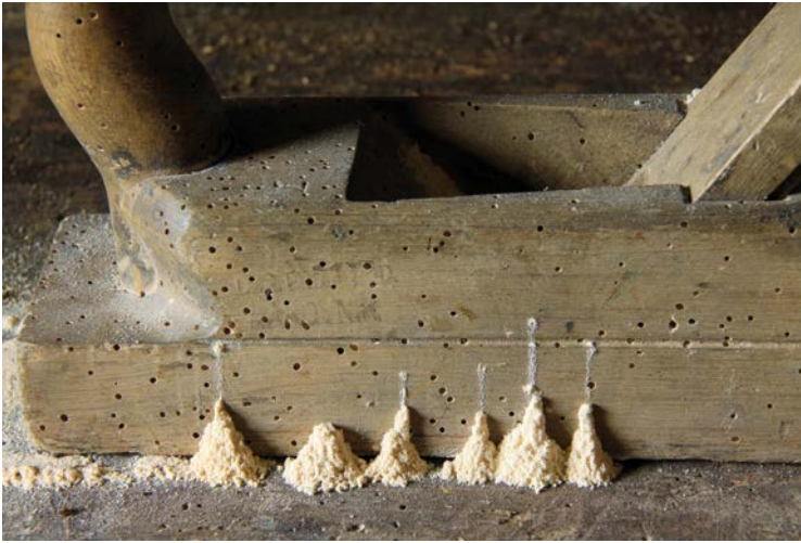
Οι οπές εξόδου του τέλειου εντόμου έχουν διαγνωστική αξία και είναι περίπου κυκλικής διατομής.
