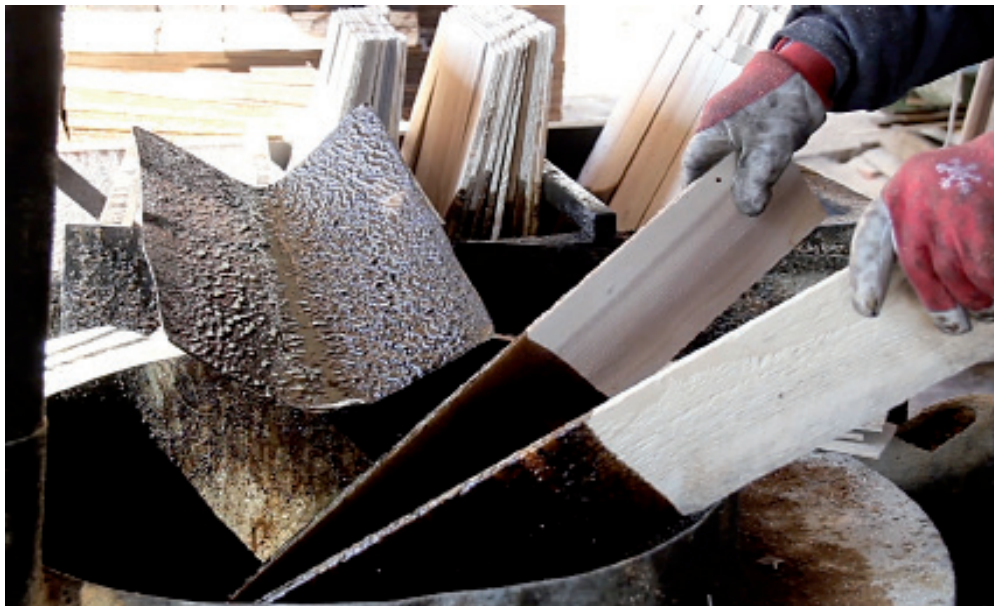
Το κατράμι είναι ένα παχύρευστο ελαιώδες μαύρο υγρό με έντονη οσμή. Η καλύτερη διάλυση και εφαρμογή του γίνεται σε αναλογία 1:1 με νέφτι ή με καλά βρασμένο λινέλαιο.
