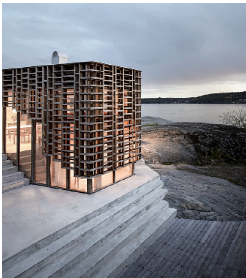
Η μέθοδος της φουρφουριλίσωσης δίνει στην ξυλεία σκούρο καφέ χρώμα και μεγάλη σκληρότητα και αντοχή, χαρακτηριστικά που την κάνουν ιδανική για επενδύσεις κτιρίων.
