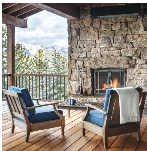
Δάπεδο από πεύκη, που έχει υποστεί θερμική τροποποίηση (thermowood), ώστε να είναι κατάλληλο για ημιυπαίθριους ή εξωτερικούς χώρους.
