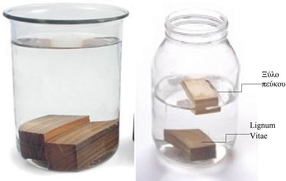
Σχήμα 2.9. Ξύλο με πυκνότητα 1,30 \text{ g/cm}^3 ( Lignum Vitae ) αριστερά και το ίδιο ξύλο μαζί με δείγμα από πεύκο, μέσα σε άλλο δοχείο δεξιά.
