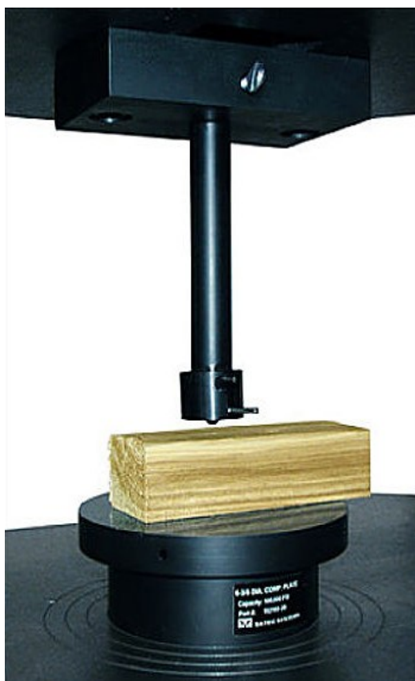
Σχήμα 5.10. Μέτρηση σκληρότητας με τη μέθοδο Janka (με έμβολο)
