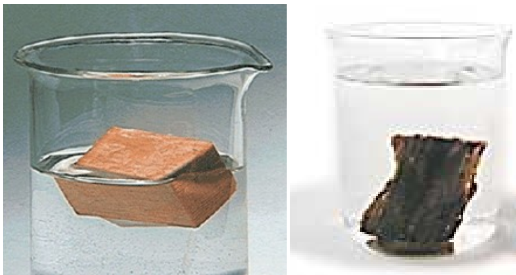
Σχήμα 2.8. Δείγμα ξύλου με πυκνότητα μικρότερη του 1 \text{ g/cm}^3 (αριστερά) και σιδηρόξυλο (πυκνότητα 1,20 \text{ g/cm}^3 ) στο δοχείο με νερό που βρίσκεται στα δεξιά.
