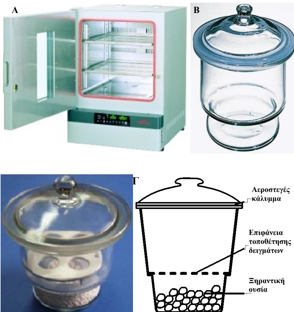
Σχήμα 2.3. A: πυριατήριο (κν. κλίβανος), B: ξηραντήρας, Γ: ξηραντήρες με ξηραντική ουσία και επιφάνεια τοποθέτησης δειγμάτων
