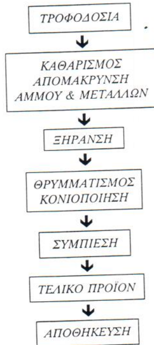
Σχήμα 1. Διάγραμμα ροής της παραγωγής συμπιεσμένου καυσόξυλου (TDR1 1983).
