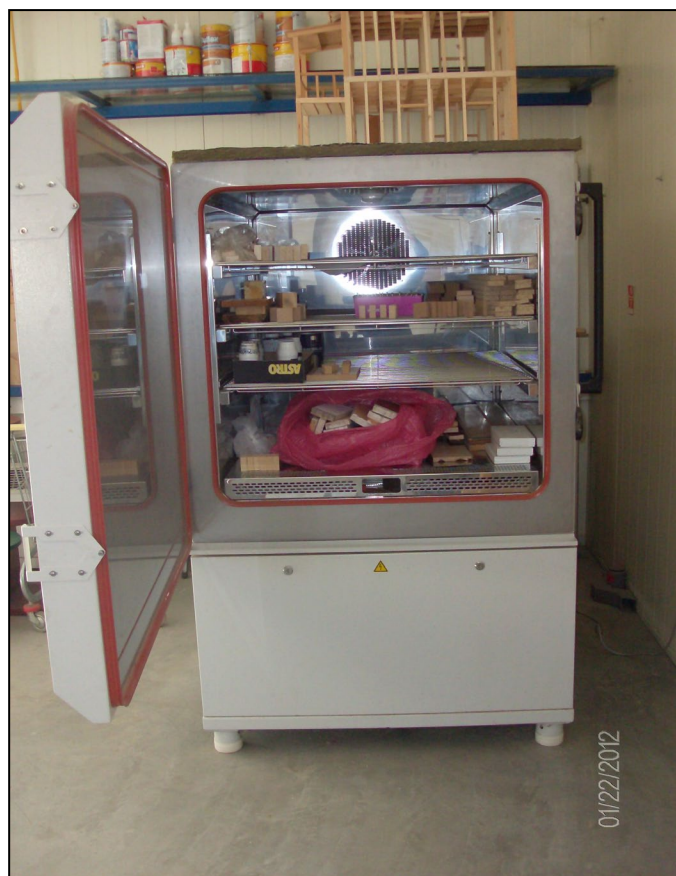
Μεγάλος θάλαμος κλιματισμού
