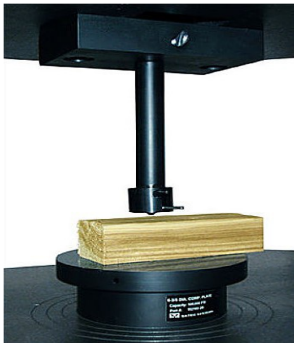
ΣΧΗΜΑ 14Δ. Φόρτιση ξύλου σε πλευρική σκληρότητα (βλ. Janka hardness test).
