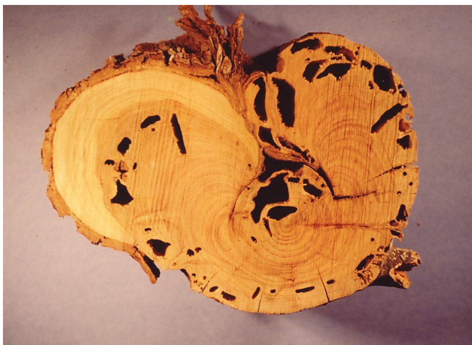
ΕΙΚΟΝΑ 9. Έντονη προσβολή κορμιδίου από τερμίτες ( termites ).
