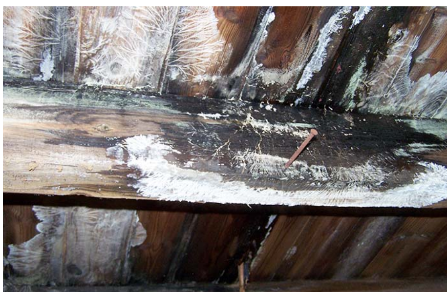
ΕΙΚΟΝΑ 3B. Τυπική εμφάνιση καστανής σήψης σε ξύλο.
