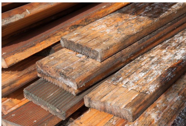
ΕΙΚΟΝΑ 2B. Μούχλα σε χλωρά δείγματα ξύλινου δαπέδου.
