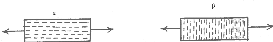
ΣΧΗΜΑ 11. Δοκίμιο ξύλου σε αξονικό εφελκυσμό (α) και εγκάρσιο εφελκυσμό (β).
