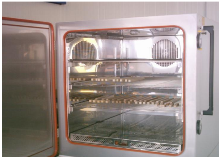
Εικ. Θάλαμος κλιματισμού τύπου Wöth.
