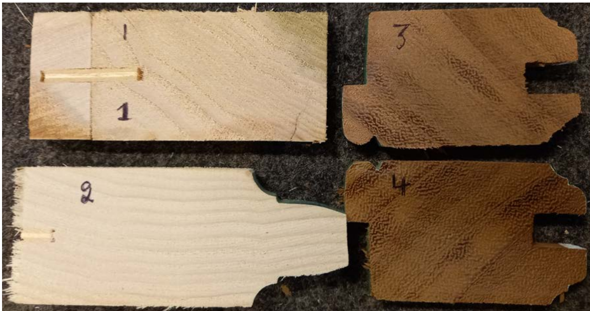
Εικ. 2. Μικρότερα δοκίμια κομμένα από τα δείγματα αριθ. 1-4 για παρατήρηση στο στερεοσκόπιο.
