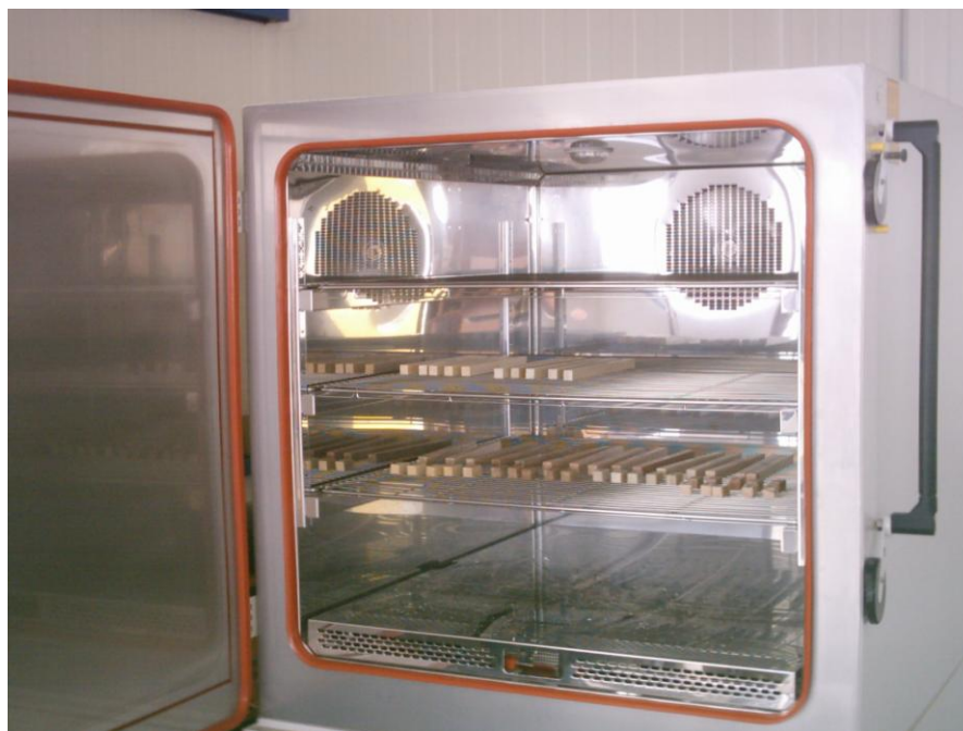
Εικόνα 2. Θάλαμος κλιματισμού όπου έγινε ο κλιματισμός των δειγμάτων.
