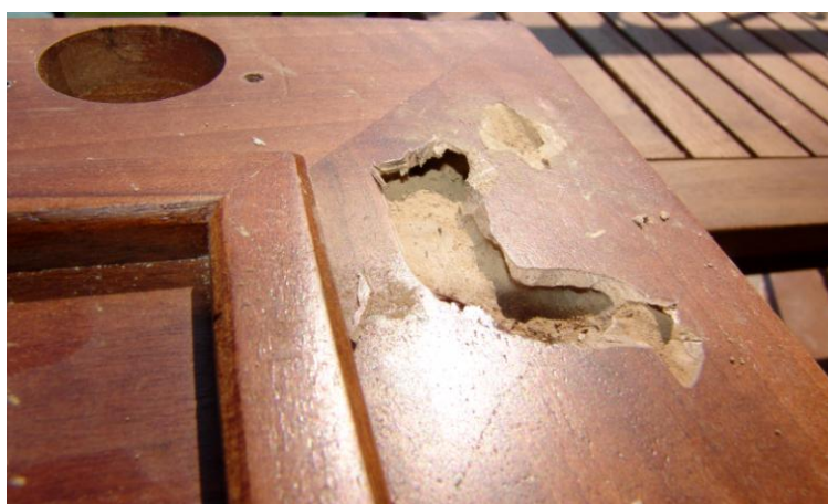
Φωτ. 12. Ορατή έκταση προσβολής με στοές στο πορτάκι του μπουφέ.
