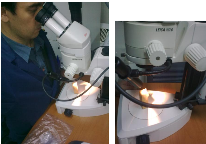
Φωτ. 17. Χρήση σύγχρονου μικροσκοπίου LEICA για αναγνώριση ξύλου
