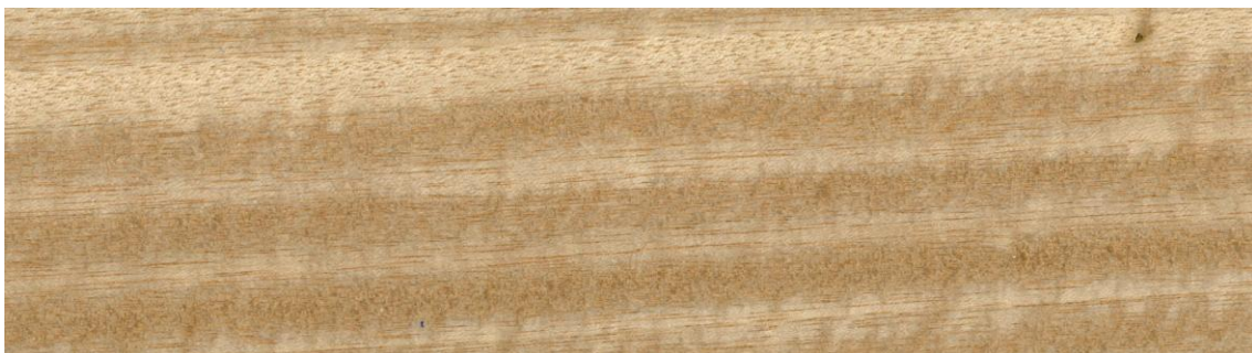
Εικόνα 1. Τα «νερά» (σχεδίαση) του δείγματος, το οποίο ανήκει στα 2 ακραία δοκίμια του επικολλητού ξυλοτεμαχίου (χρώμα: κιτρινωπό έως ανοιχτό κοκκινωπό )
