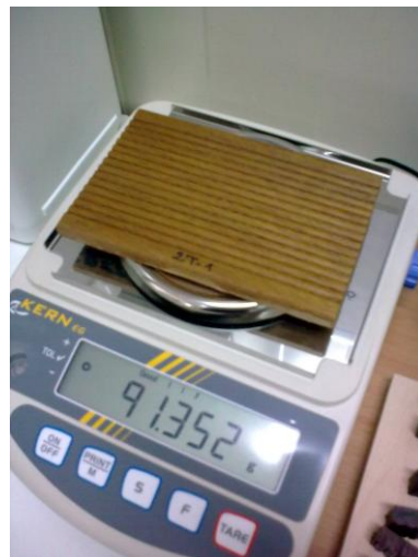
Εικ. 10. A) Δείγμα μετά 2h διόγκωση, με παχυμέτρηση ακριβείας ( ακτινική διόγκωση ), B) Ζύγιση του δείγματος, μετά τη διαβροχή, για να βρεθεί το «υγρό βάρος» του, δηλ. να προκύψει από τη διαφορά (=τελικό υγρό - αρχικό ξηρό βάρος) η μάζα νερού που απορροφήθηκε από την ξύλινη επιφάνεια μετά τον ψεκασμό.
