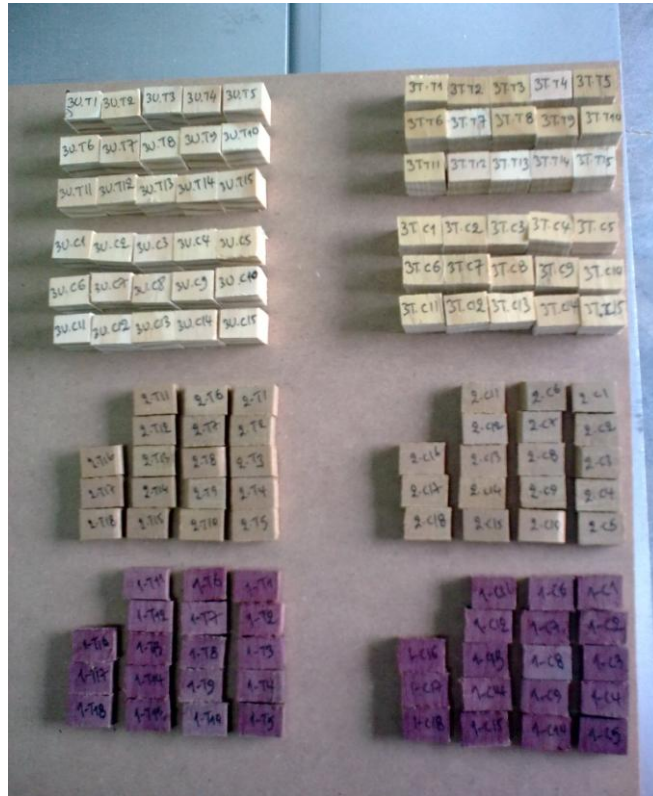
Εικ. 2. Κομμένα μικρά δοκίμια (όλα τα είδη) για το τεστ της διόγκωσης σε νερό (πριν την εμφάτιση στο ναυοσκεύασμα)
