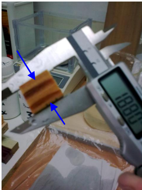
Εικ. 10. A) Δείγμα μετά 2h διόγκωση, με παχυμέτρηση ακριβείας ( ακτινική διόγκωση ), B) Ζύγιση του δείγματος, μετά τη διαβροχή, για να βρεθεί το «υγρό βάρος» του, δηλ. να προκύψει από τη διαφορά (=τελικό υγρό - αρχικό ξηρό βάρος) η μάζα νερού που απορροφήθηκε από την ξύλινη επιφάνεια μετά τον ψεκασμό.
