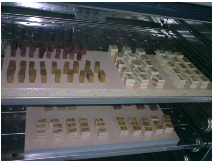
Εικ. 1. Δοκίμια σε ειδικό θάλαμο για κλιματισμό 7 days σε συνθήκες 20/65.
