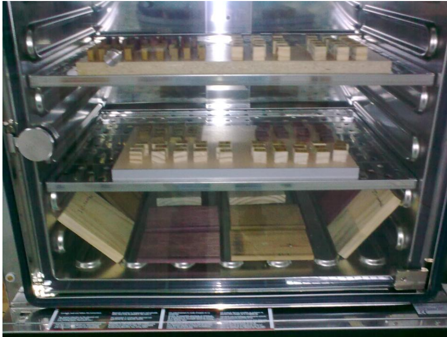
Εικ. 6. Όλα τα δείγματα από τα παρκέτα όπως κλιματίζονται 2 days σε κανονικό κλίμα (η φωτογραφία πάρθηκε μετά την επάλειψη στα μεγάλα δείγματα, και μετά την 2μην εμβάπτιση στα μικρά δείγματα)
