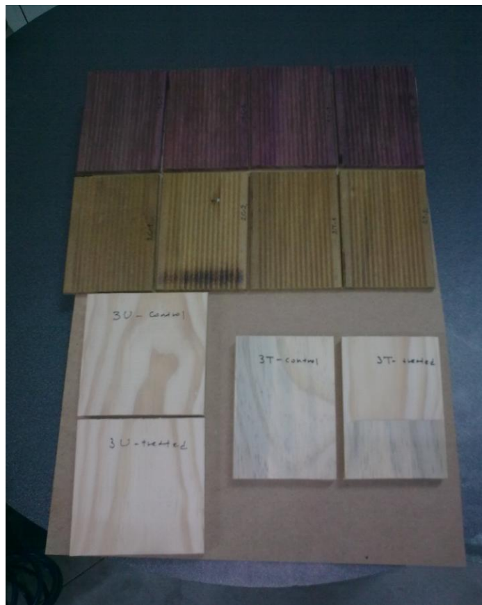
Εικ. 3. Κομμένα μεγάλα δοκίμια (από όλα τα είδη) για το τεστ της διαβροχής με ψεκασμό (πριν τη δοκιμή διαβροχής)
