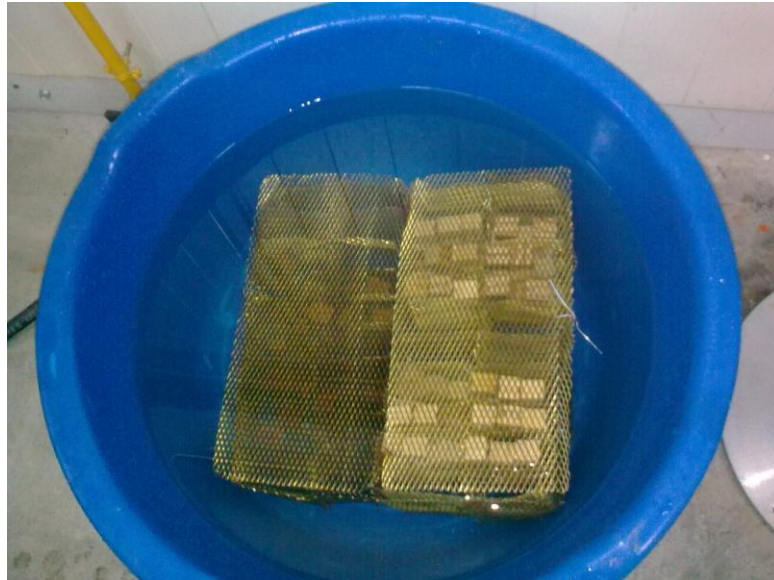
Εικ. 9. Πλαστική λεκάνη όπου έγιναν οι μετρήσεις 2h διόγκωσης σε νερό στους 20-22°C (μικρά δείγματα από τα παρκέτα υπό διόγκωση μέσα σε πλέγμα- πλήρης βύθιση)
