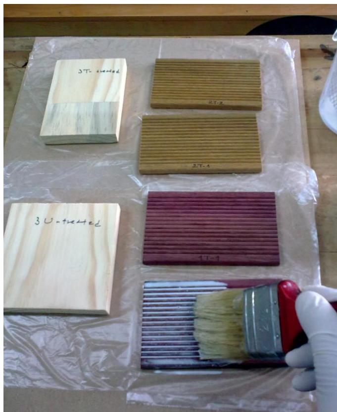
Εικ. 5. Διαδικασία χειρισμού επάλειψης με πινέλο της επιφάνειας του παρκέτου (μόνον από την μία πλευρά).
