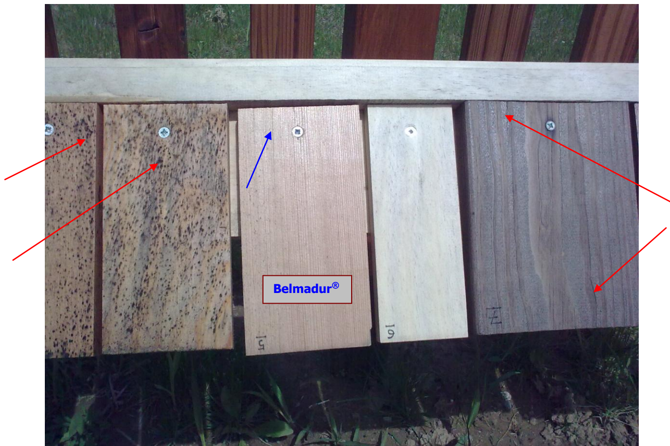
Εικ. 3: Εξωτερική εμφάνιση των δοκιμών ξύλου στις αρχές Απριλίου 2011 (2-4-2011). Με κόκκινα βέλη φαίνονται δείγματα (αριστερά) που έχουν υποστεί έντονη κυάνωση και δείγμα (δεξιά κόκκινα βέλη) με αρχικές ραγαδώσεις και σχετική παραμόρφωση επιφάνειας.
