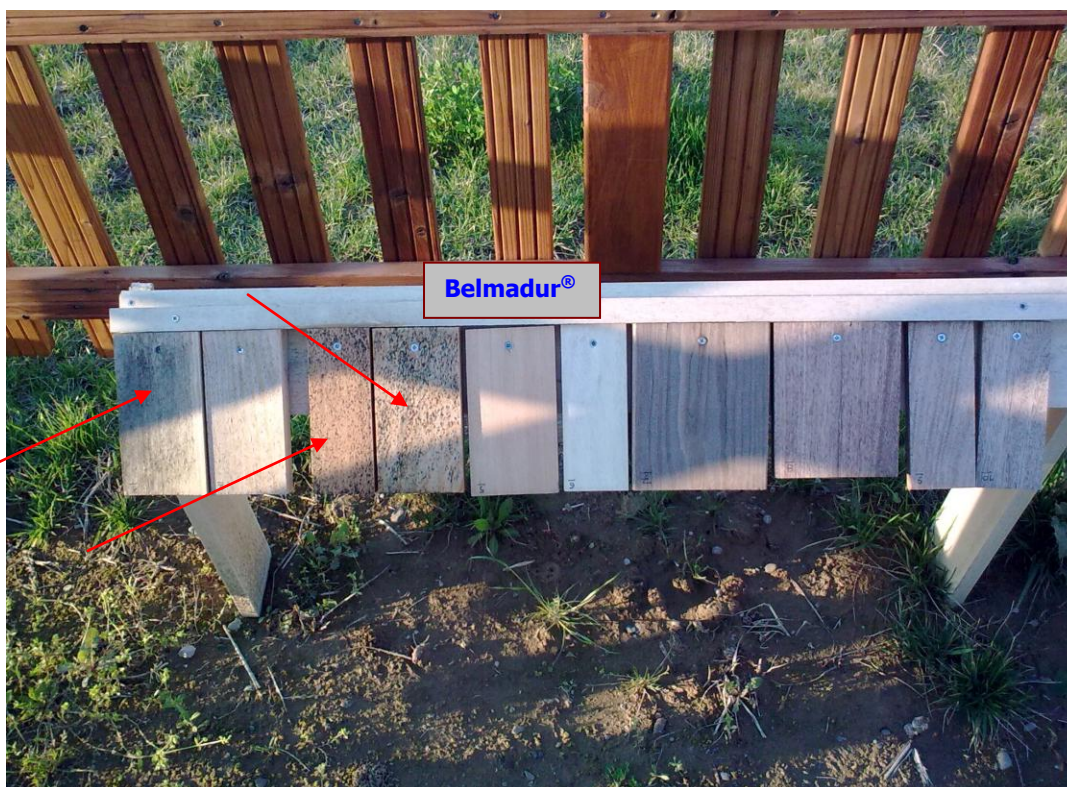
Εικ. 2: Εξωτερική εμφάνιση των δοκιμών ξύλου την 24-Μαρτ-2011. Με βέλη φαίνονται δείγματα που έχουν υποστεί έντονη κυάνωση (σκουρόχρωμους μεταχρωματισμούς) χωρίς όμως σημάδια σήψης.
