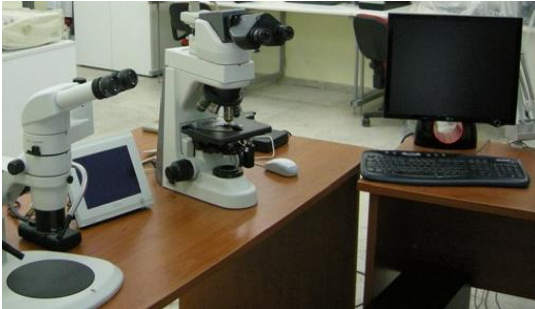
Εικ. 4. Οι 2 συσκευές μικροσκοπίας που χρησιμοποιήθηκαν (μικροσκόπιο Nikon Eclipse 50i με κάμερα, στερεοσκόπιο Nikon SM2 800)
