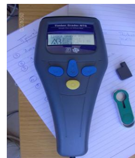
Εικ. 5. Συσκευή MTG για κλάσεις αντοχής ξυλείας (ref. http://bmehuis.hangartachtig.nl ) (εικόνες από τις ανεπιτυχείς δοκιμές στο Εργαστήριο Τεχνολογίας Ξύλου λόγω ζημίας)
