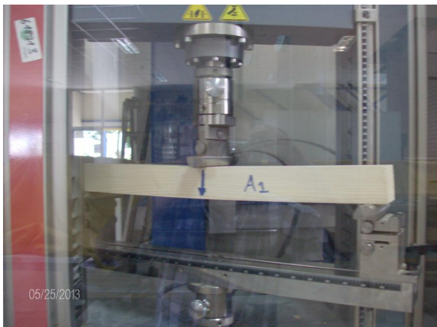
Εικ. 6. Δοκίμιο Ερυθρελάτης «Α1», την ώρα της δοκιμής του σε θραύση (MOR) σε συσκευή τύπου Zwick-Roell 2020 testing machine (Software testXpert V10.11) του Εργαστηρίου Τεχνολογίας Ξύλου του Τ.Ε.Ι. Λάρισας
