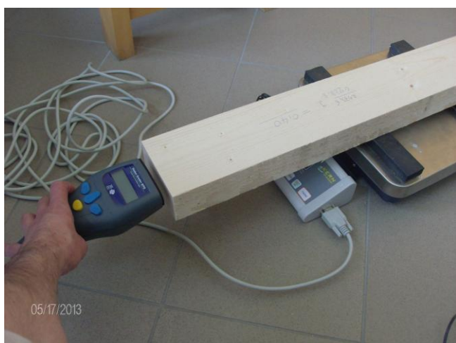
Εικ. 5. Συσκευή MTG για κλάσεις αντοχής ξυλείας (ref. http://bmehuis.hangartachtig.nl ) (εικόνες από τις ανεπιτυχείς δοκιμές στο Εργαστήριο Τεχνολογίας Ξύλου λόγω ζημίας)
