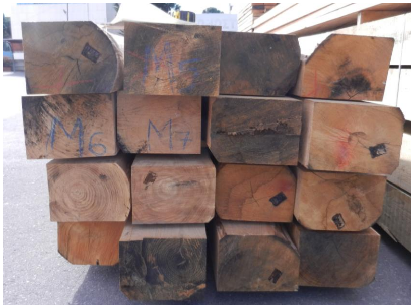
Εικόνα 2: Δειγματοληψία από τεμάχια διατομής 18x25cm.
