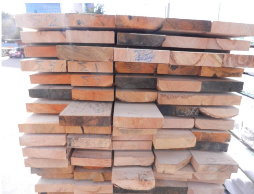
Εικόνα 4: Δειγματοληψία από τεμάχια διατομής 21x4cm.
