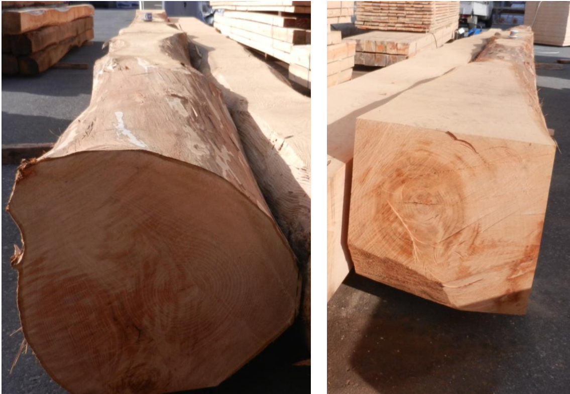
Εικόνα 1: Οι δυο εγκάρσιες επιφάνειες της μιας από τις 2 κυριες δοκούς (διατομή 50x50cm).
