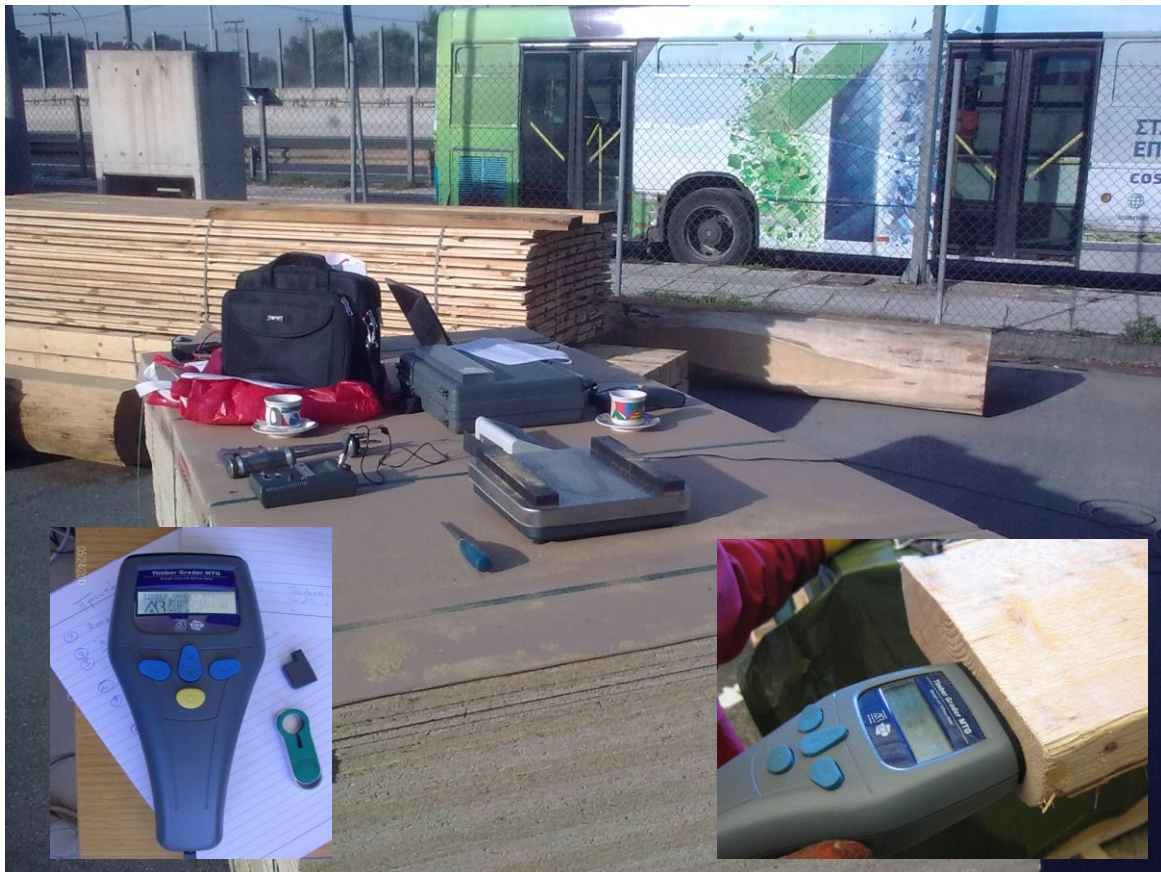
Εικόνα 5: Τα όργανα της μελέτης (σύστημα Timber Grader MTG 860 της Brookhuis) για ταξινόμηση της ξυλείας καστανιάς σε κλάση μηχανικής αντοχής (D24, D27, D30 κ.ο.κ.)
