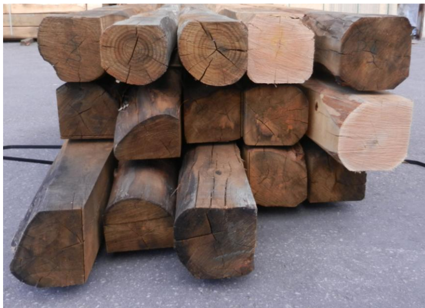
Εικόνα 3: Δειγματοληψία από τεμάχια διατομής 18x18cm.
