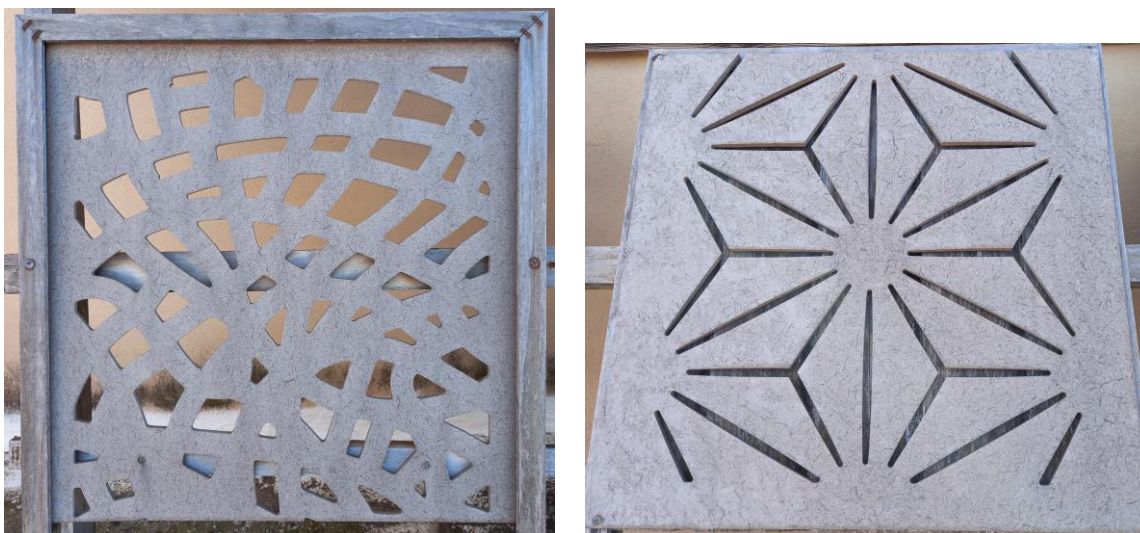
Εικ. 3. Κοντινή άποψη από δύο διαφορετικά πάνελ μετά την παρέλευση δύο ετών έκθεσης.
