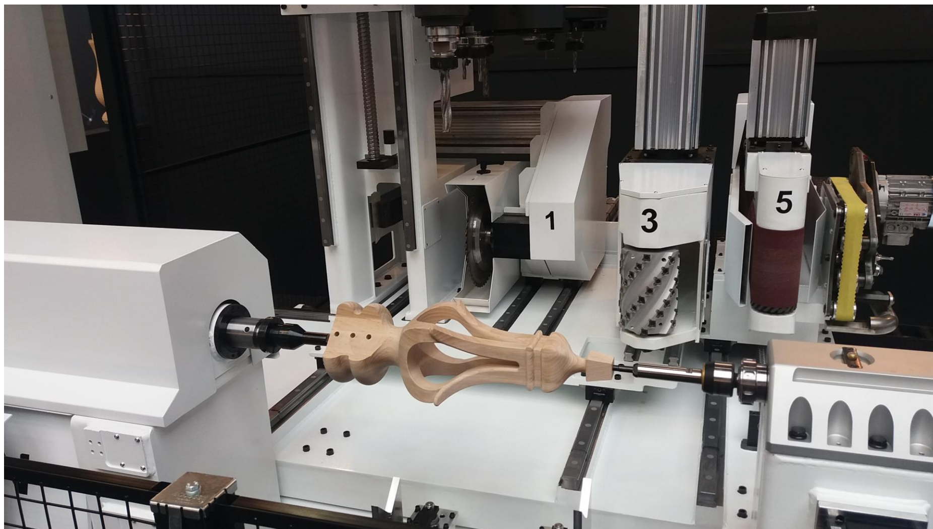
Φωτογραφία από ειδικό σύγχρονο μηχάνημα αυτόματης μηχανικής μορφοποίησης του ξύλου.
