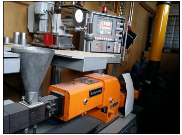
Φωτ. από την επίδειξη παραγωγής WPC που μας έγινε στο pilot plant ( extruder )
