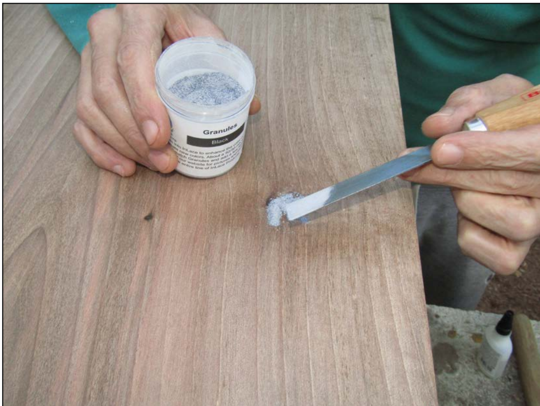
Εικόνα 120. Τοποθέτηση εποξειδικής ρητίνης, σε σκόνη (Φωτ. Προσωπικό αρχείο).
