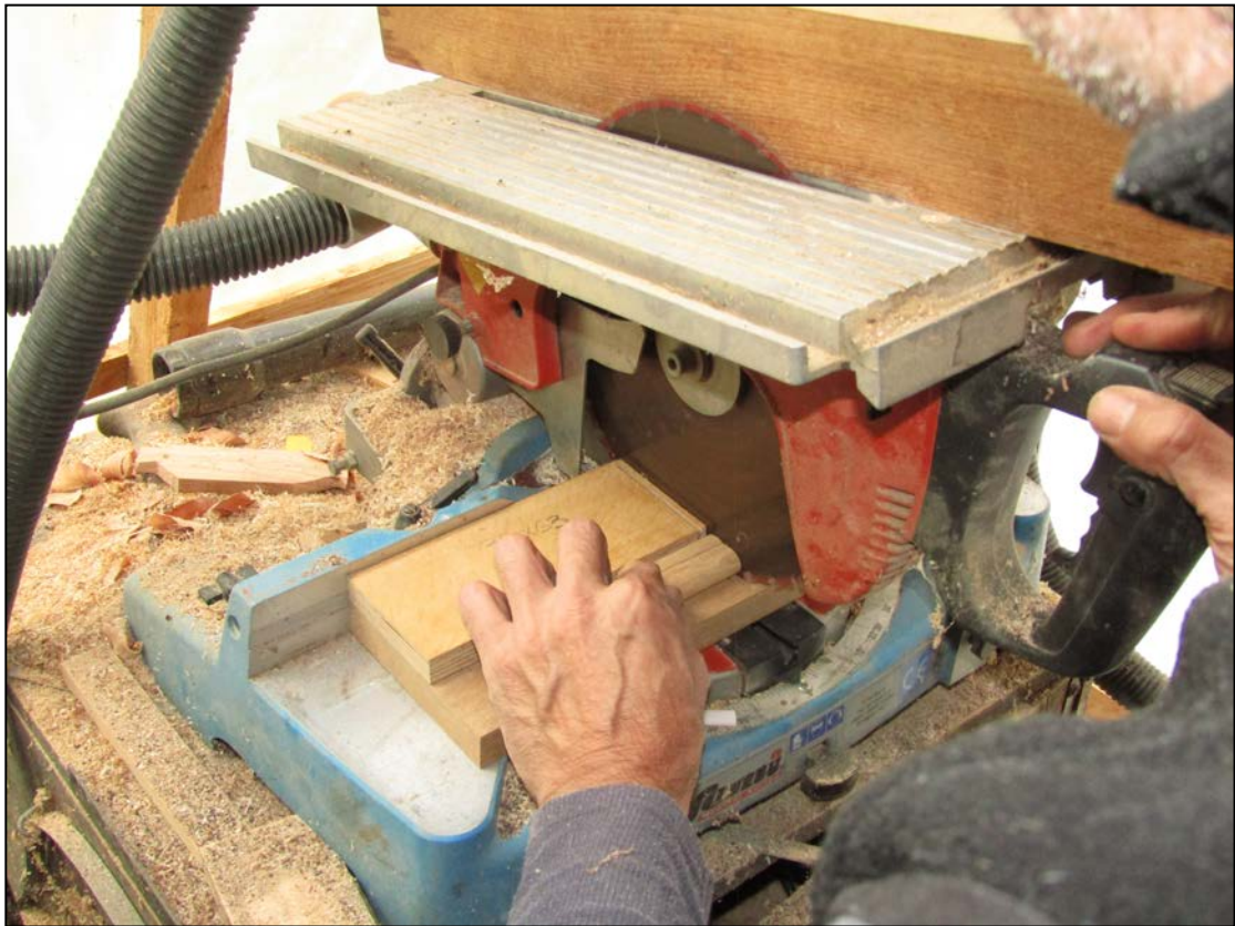
Εικόνα 112. Κατασκευή καβίλων (Φωτ. Προσωπικό αρχείο).
