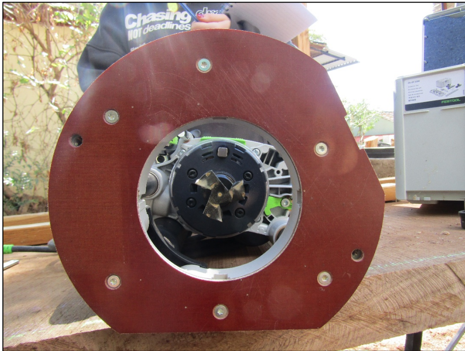
Εικόνα 33. Βάση και κοπτικό του ρούτερ (Φωτ. Προσωπικό αρχείο).
