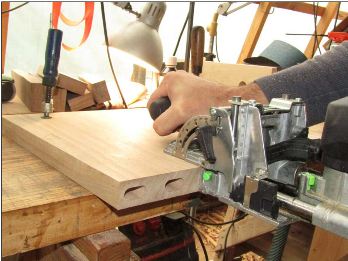
Εικόνα 111α. Δημιουργία σπών με φρεζοκαβιλιέρα (Φωτ. Προσωπικό αρχείο).
