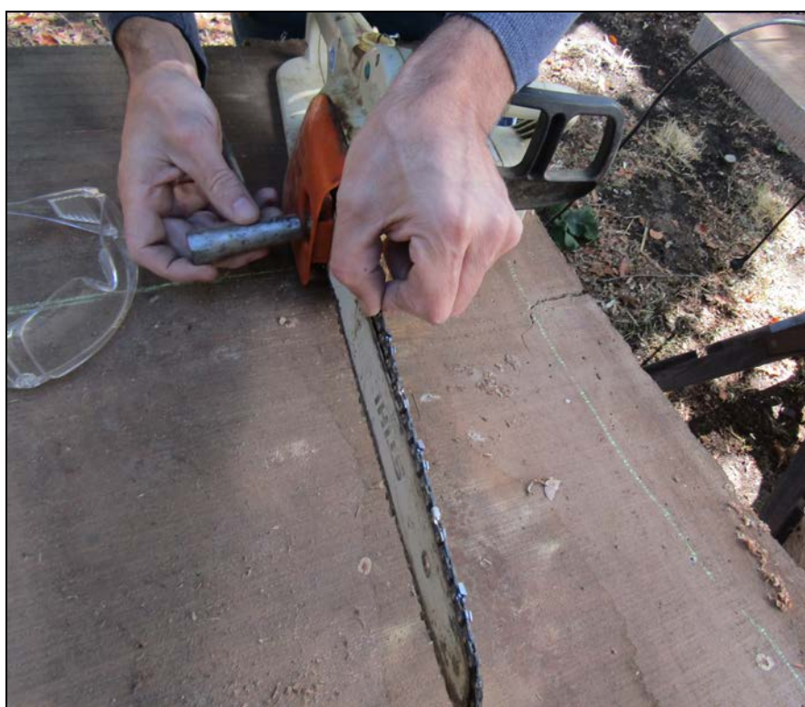
Εικόνα 28. Ρύθμιση αλυσοπρίονου (Φωτ. Προσωπικό αρχείο).
