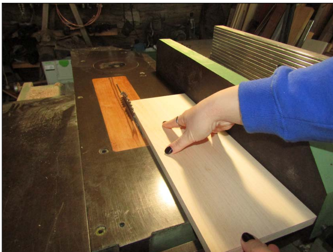
Εικόνα 137. Πλάνισμα, κατά πλάτος, τεμαχίων των συρταριών (Φωτ. Προσωπικό αρχείο).
