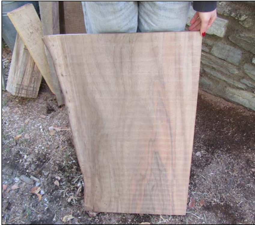
Εικόνα 38α. Δεύτερο πέρασμα με ρούτερ (Φωτ. Προσωπικό αρχείο).
