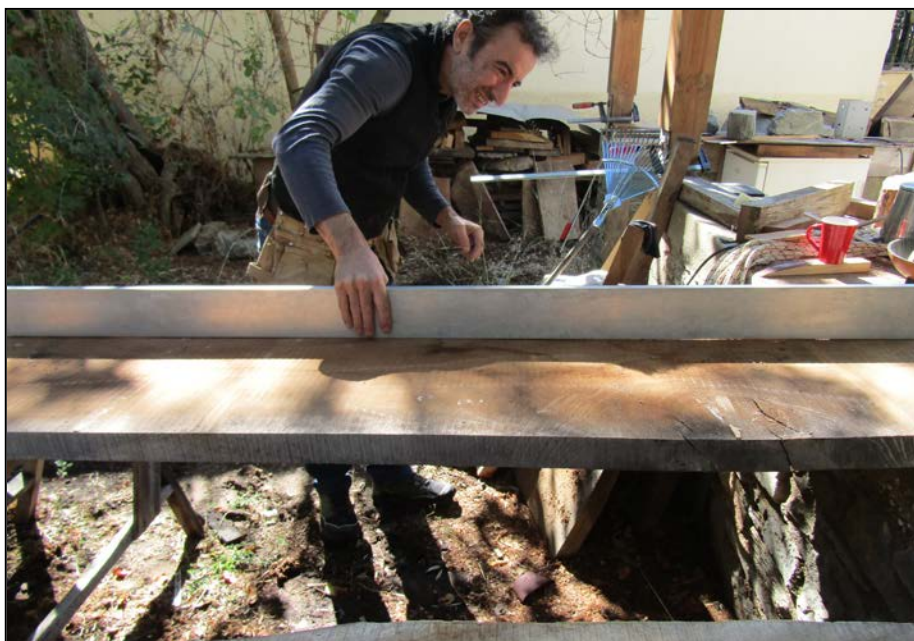
Εικόνα 27. Έλεγχος πιθανής καμπυλότητας (Φωτ. Προσωπικό αρχείο).
