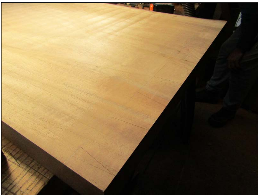
Εικόνα 76. Σημάδια των δοντιών στο ξύλο (Φωτ. Προσωπικό αρχείο).
