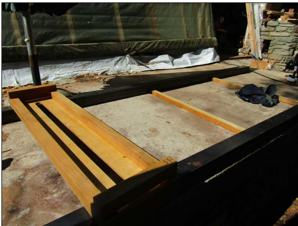
Εικόνα 34. Αυτοσχέδια βάση του ρούτερ (Φωτ. Προσωπικό αρχείο).
