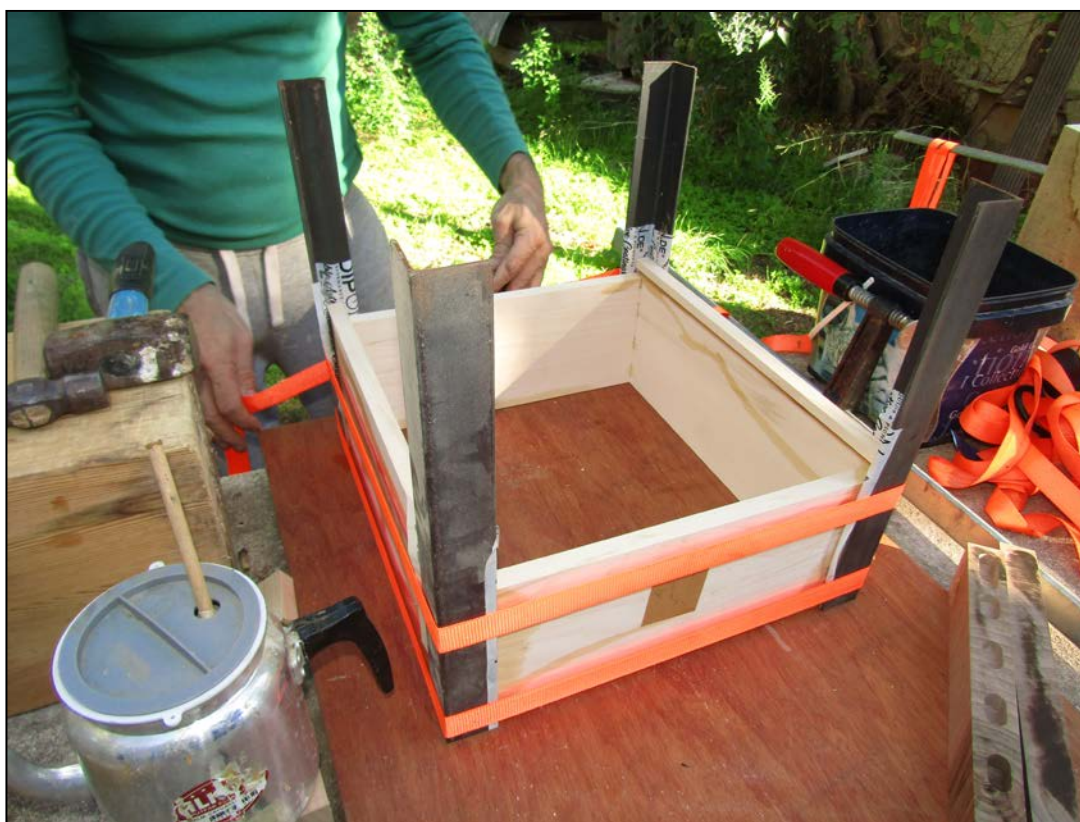
Εικόνα 150. Σύσφιξη των συρταριών, με ιμάντες (Φωτ. Προσωπικό αρχείο).
