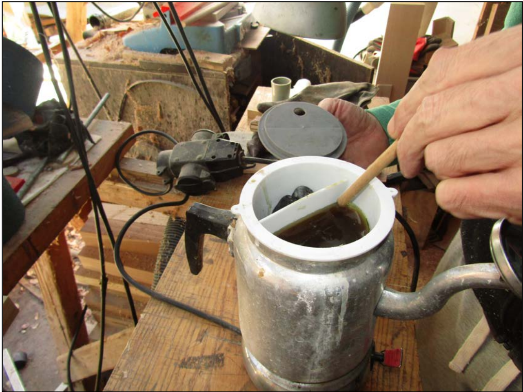
Εικόνα 146β. Θέρμανση ζωικής κόλλας (Φωτ. Προσωπικό αρχείο).
