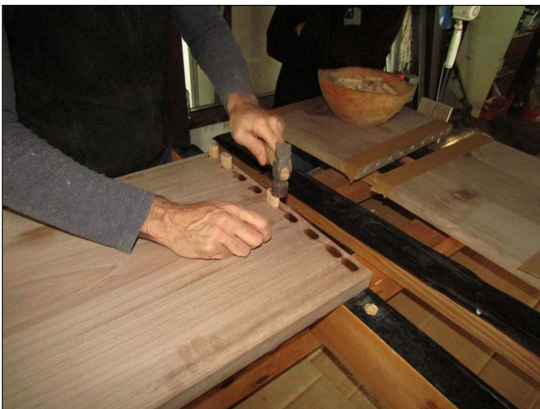
Εικόνα 114. Συγκόλληση των τεμαχίων του κουτιού (Φωτ. Προσωπικό αρχείο).
