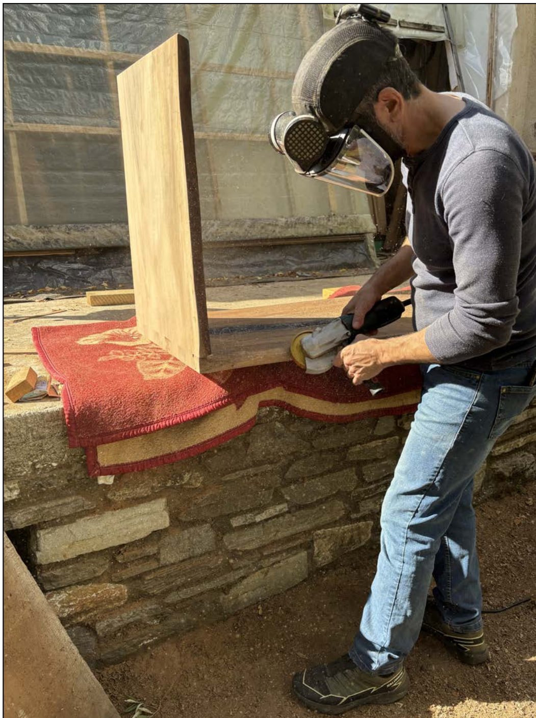
Εικόνα 93α. Μορφοποίηση μπροστινής όψης του γραφείου (Φωτ. Προσωπικό αρχείο).
