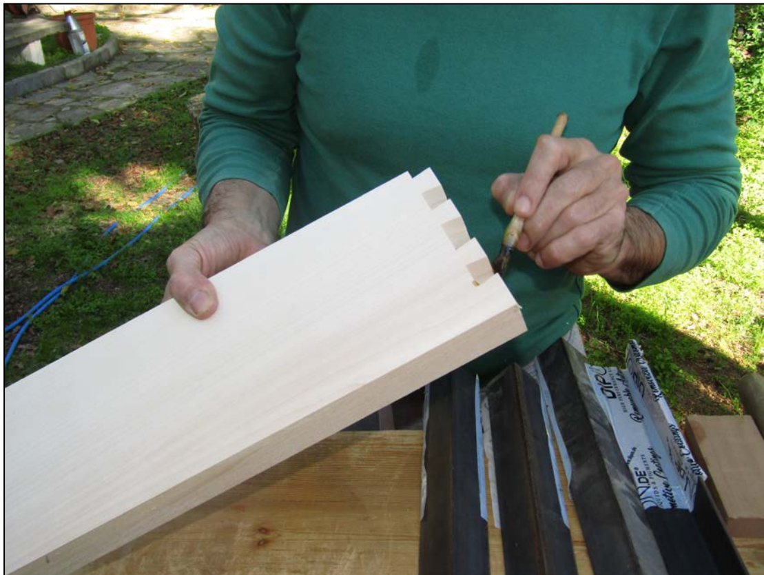
Εικόνα 148. Επάλειψη της κόλλας (Φωτ. Προσωπικό αρχείο).
