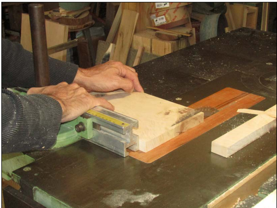
Εικόνα 159β. Τεμαχισμός των τριών προσόψεων (Φωτ. Προσωπικό αρχείο).
