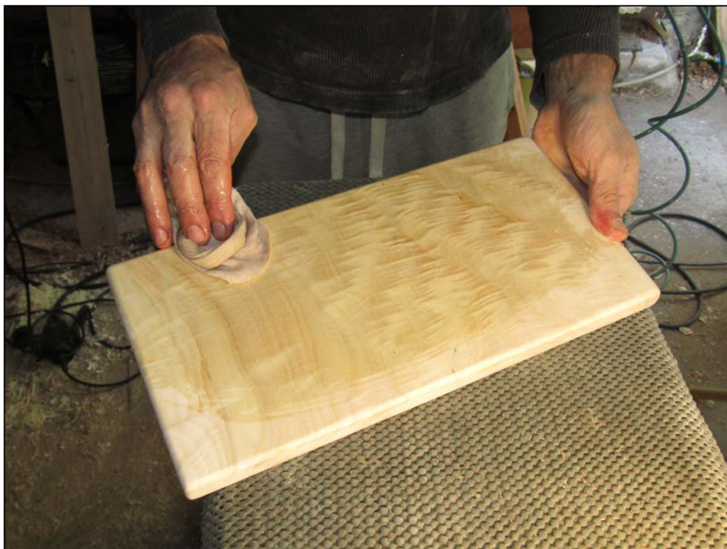
Εικόνα 163. Διαβροχή των προσόψεων (Φωτ. Προσωπικό αρχείο).
