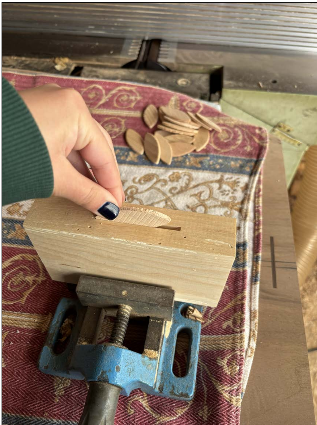
Εικόνα 101. Επιλογή των λαμέλων κατάλληλου μεγέθους (Φωτ. Προσωπικό αρχείο).
