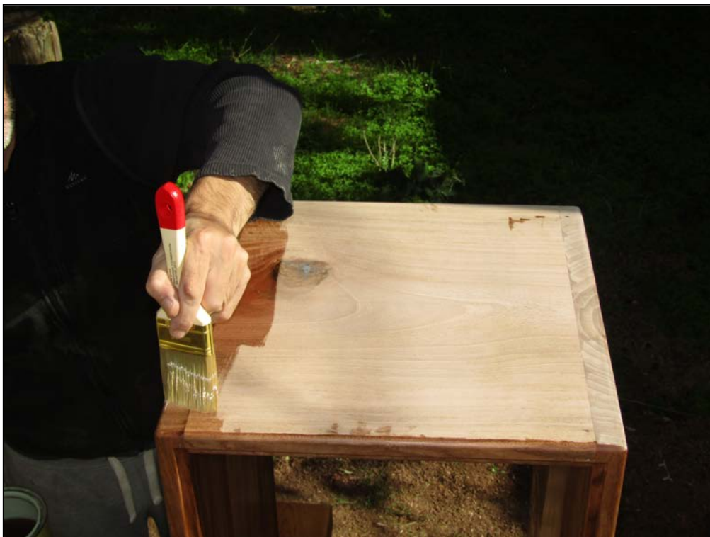
Εικόνα 69. Λάδωμα ξύλινης επιφάνειας (Φωτ. Προσωπικό αρχείο).
