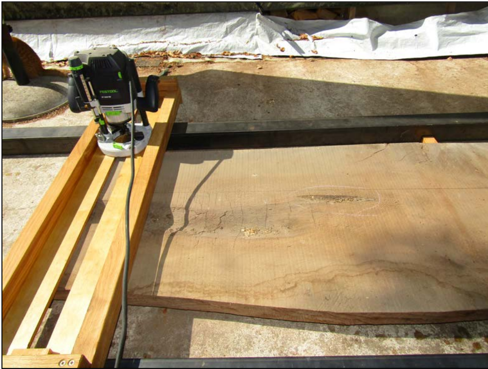
Εικόνα 35. Εφαρμογή του ρούτερ στην βάση (Φωτ. Προσωπικό αρχείο).
