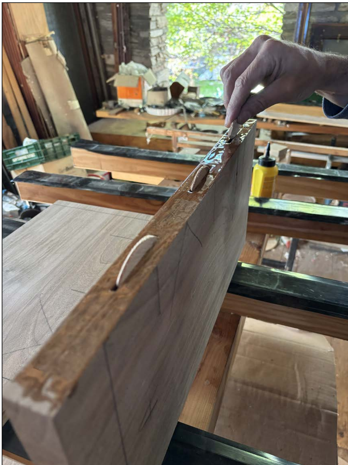
Εικόνα 105. Τοποθέτηση λαμέλων (Φωτ. Προσωπικό αρχείο).
