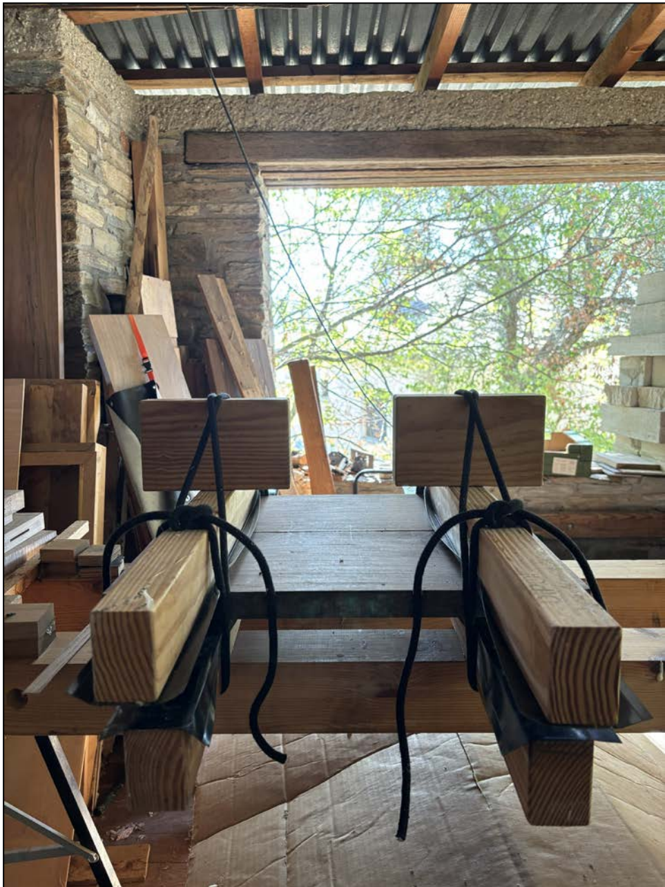
Εικόνα 67β. Ιαπωνικός τρόπος σύσφιξης (Φωτ. Προσωπικό αρχείο).
