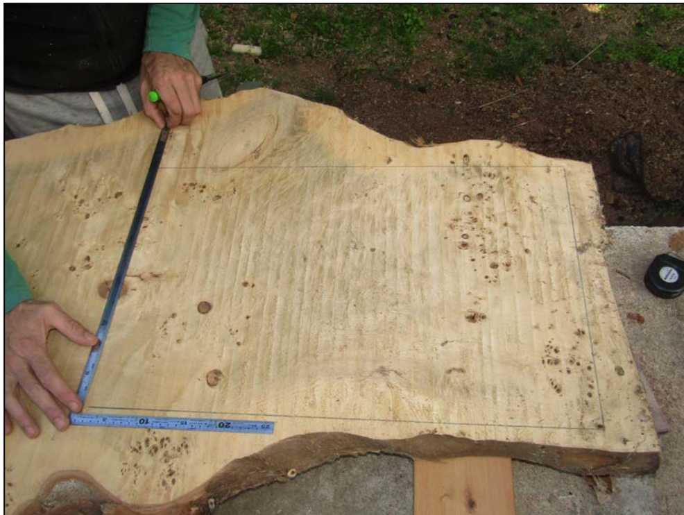
Εικόνα 152. Σημάδεμα ενιαίου τεμαχίου για τις προσόψεις (Φωτ. Προσωπικό αρχείο).
