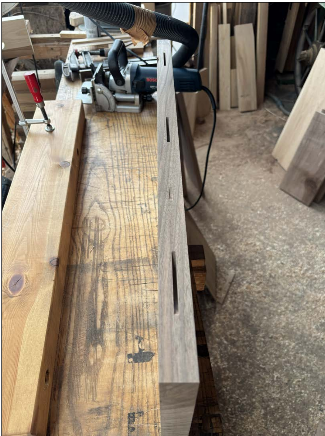
Εικόνα 103. Εσοχές λαμέλων (Φωτ. Προσωπικό αρχείο).
