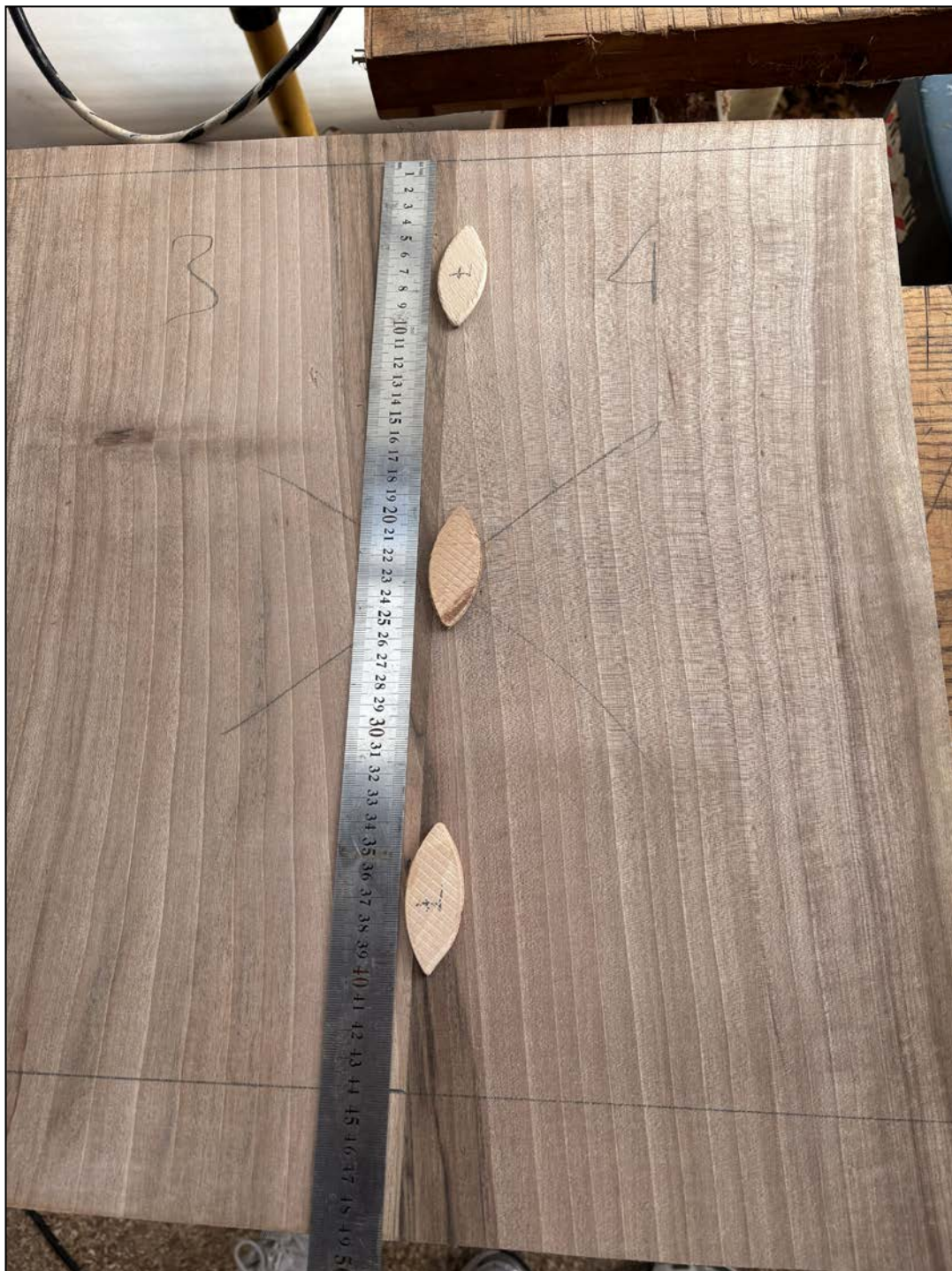
Εικόνα 100. Σημάδεμα των θέσεων των λαμέλων (Φωτ. Προσωπικό αρχείο).
