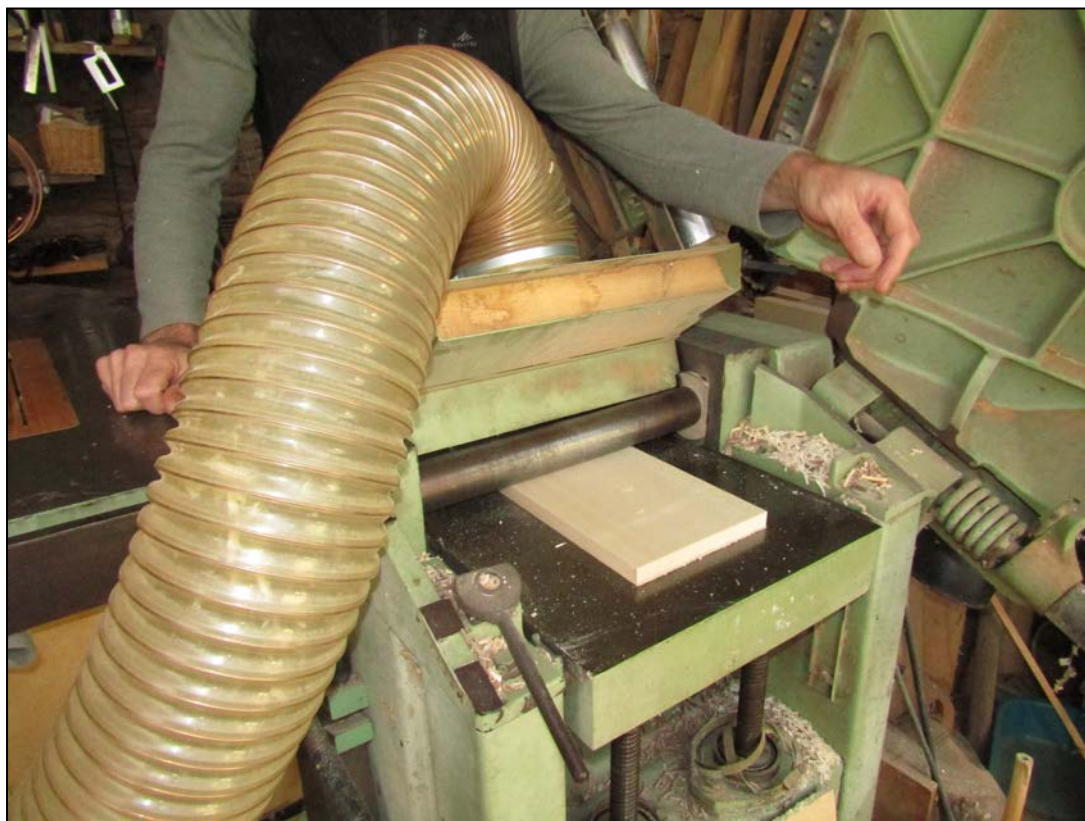
Εικόνα 135. Ξεχόνδρισμα των τεμαχίων των συρταριών (Φωτ. Προσωπικό αρχείο).
