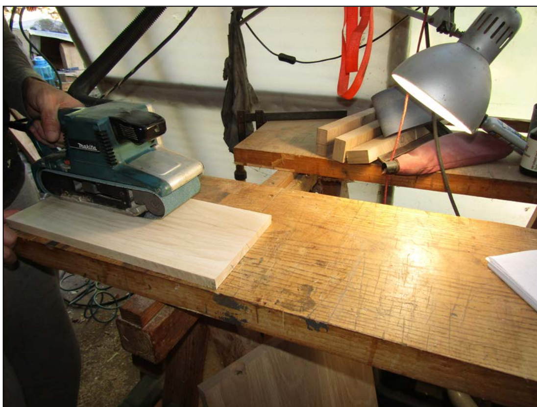
Εικόνα 135. Ξεχόνδρισμα των τεμαχίων των συρταριών (Φωτ. Προσωπικό αρχείο).
