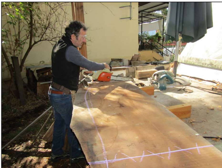
Εικόνα 29. Πρίση με αλυσοπρίο (Φωτ. Προσωπικό αρχείο).
