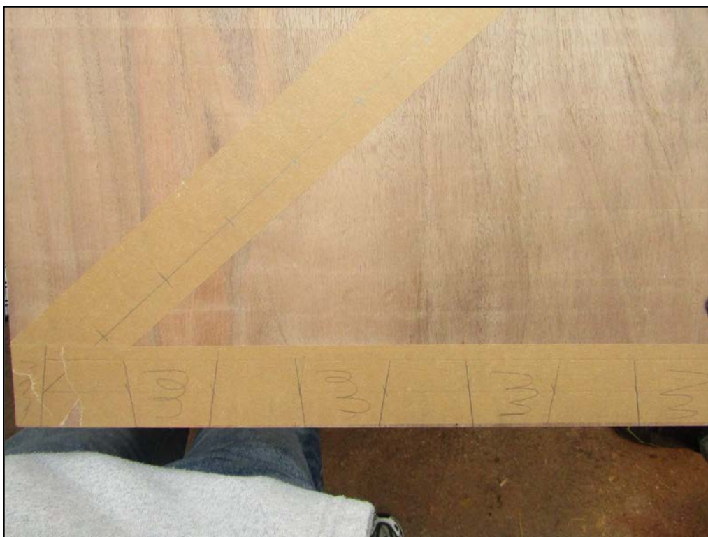
Εικόνα 74. Σημάδια των δοντιών στην χαρτοταινία (Φωτ. Προσωπικό αρχείο).
