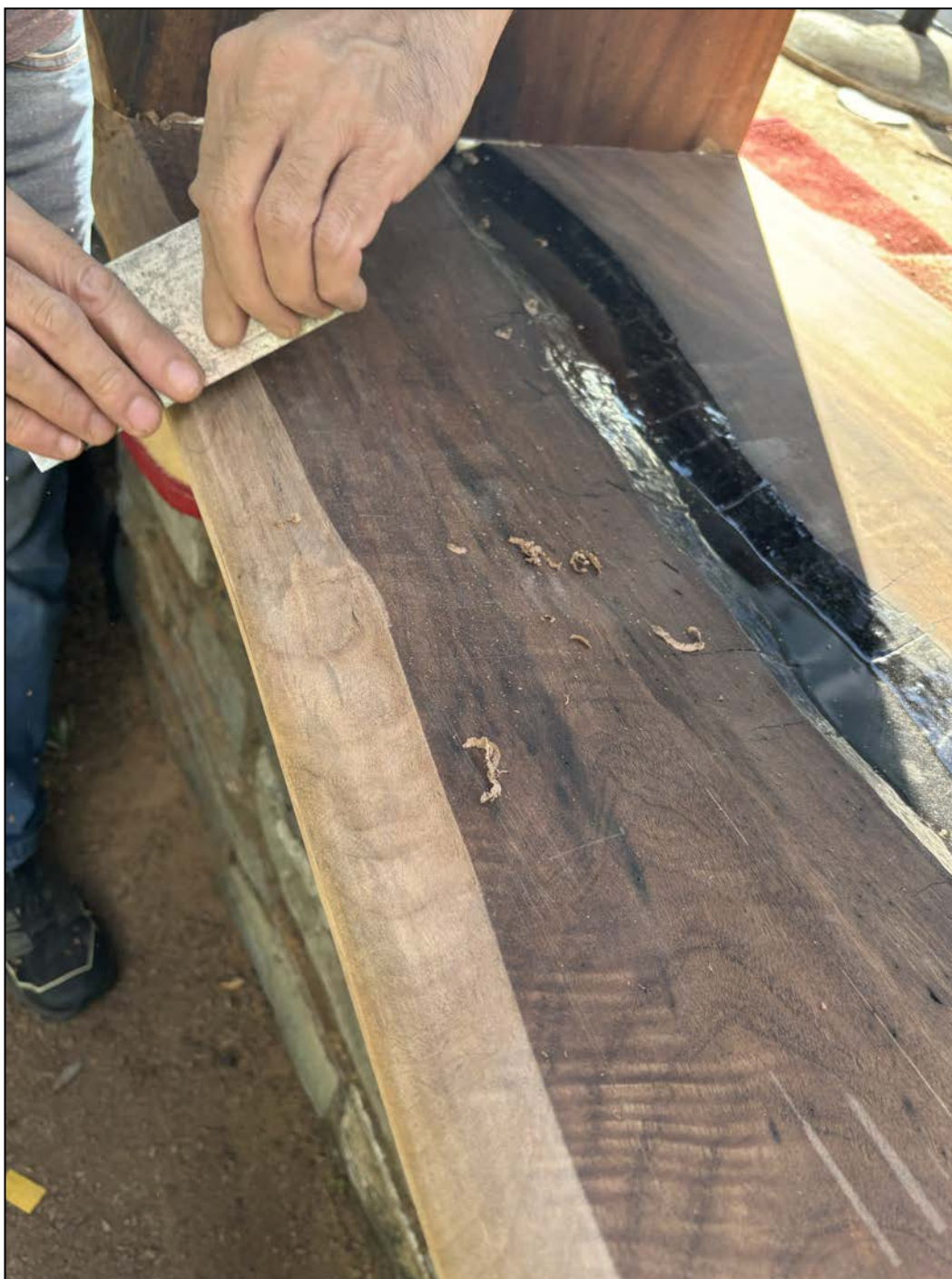
Εικόνα 93β. Μορφοποίηση μπροστινής όψης του γραφείου (Φωτ. Προσωπικό αρχείο).
