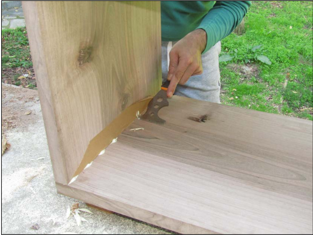
Εικόνα 119. Αφαίρεση της περίσσειας κόλλας (Φωτ. Προσωπικό αρχείο).
