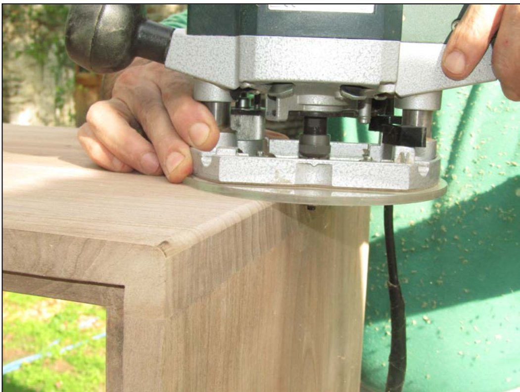
Εικόνα 128α. Καμπύλωση των ακμών και πλευρών του κουτιού, με ρούτερ (Φωτ. Προσωπικό αρχείο).
