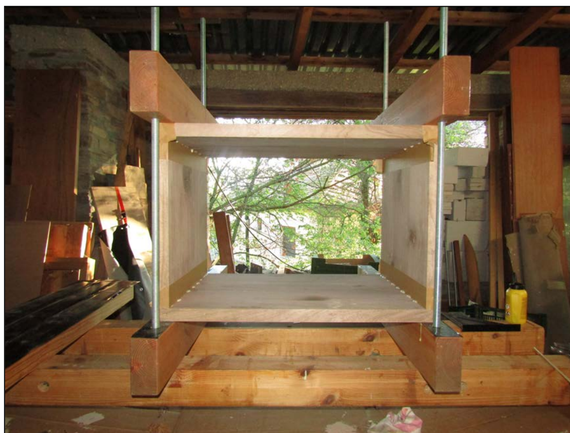
Εικόνα 117α. Σύσφιξη του κουτιού με μεταλλικές ντίζες (Φωτ. Προσωπικό αρχείο).
