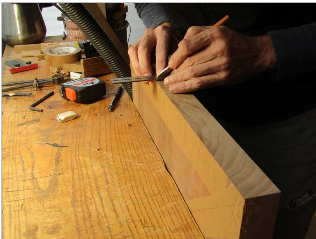
Εικόνα 75. Χάραξη των σημαδιών στο ξύλο (Φωτ. Προσωπικό αρχείο).
