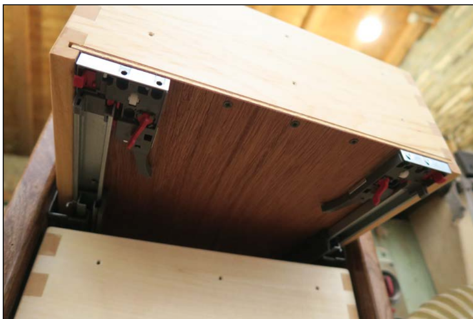
Εικόνα 164β. Τοποθέτηση σιδηροδρόμων (Φωτ. Προσωπικό αρχείο).
