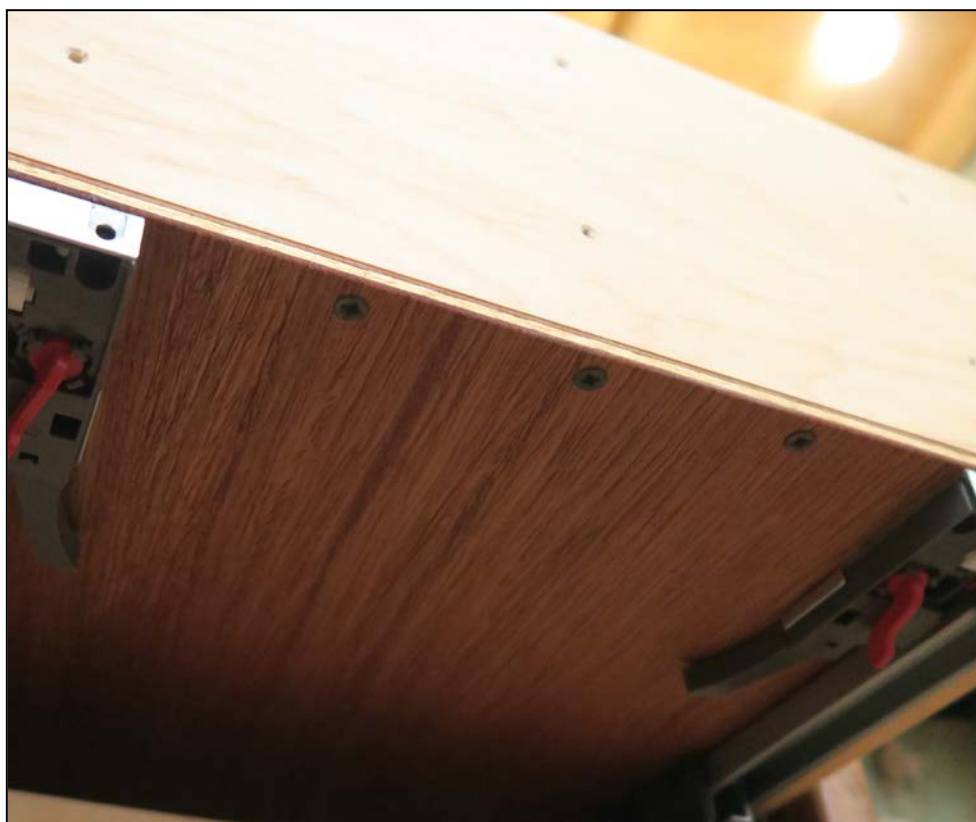
Εικόνα 151β. Τοποθέτηση πατωμάτων στα συρτάρια (Φωτ. Προσωπικό αρχείο).
