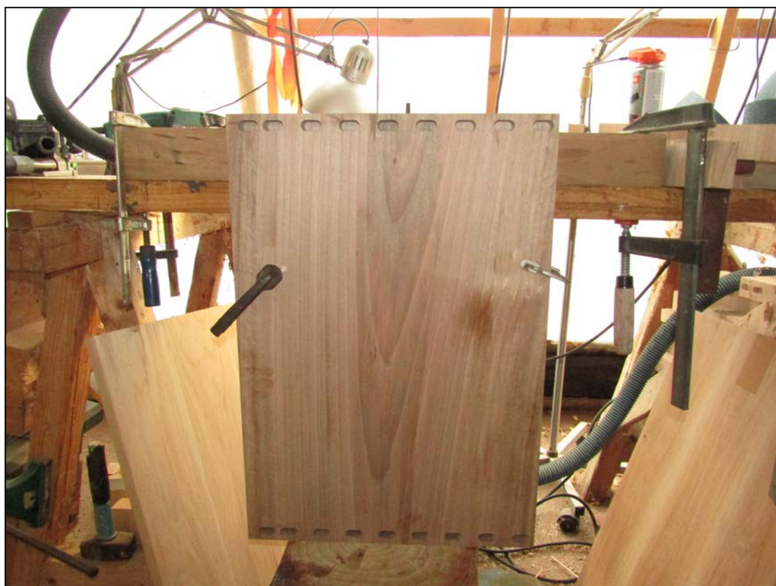
Εικόνα 111α. Δημιουργία σπών με φρεζοκαβιλιέρα (Φωτ. Προσωπικό αρχείο).
