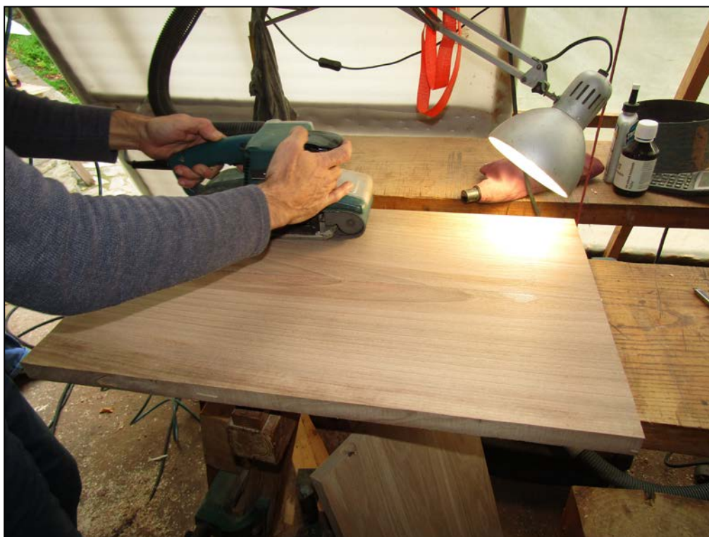
Εικόνα 108. Αφαίρεση της περίσσειας κόλλας (Φωτ. Προσωπικό αρχείο).
