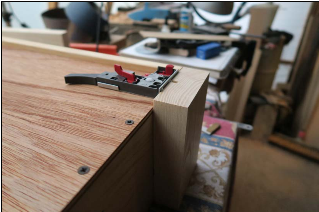
Εικόνα 151α. Τοποθέτηση πατωμάτων στα συρτάρια (Φωτ. Προσωπικό αρχείο).
