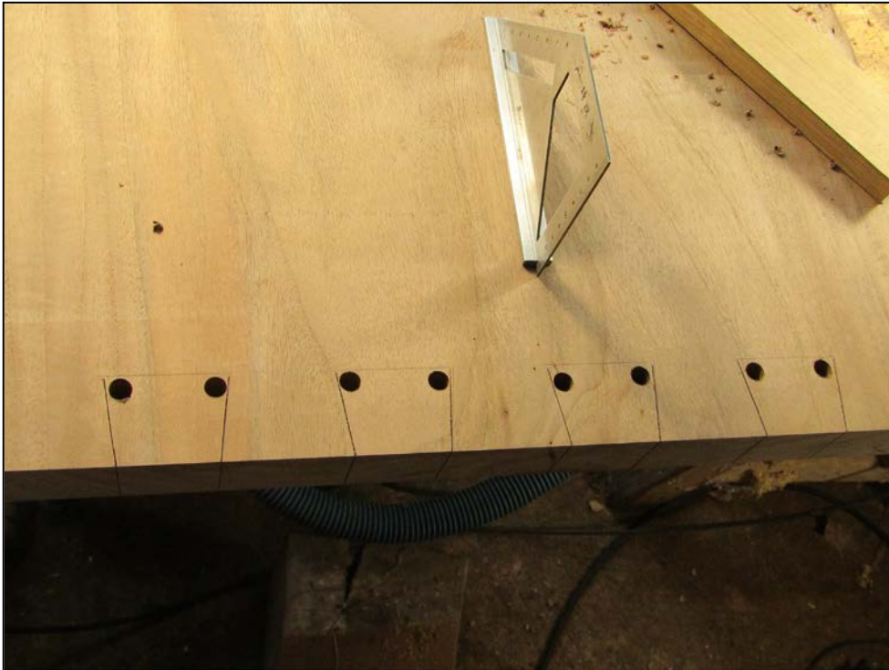
Εικόνα 79. Οπές από δρέπανο με τρυπάνι (Φωτ. Προσωπικό αρχείο).
