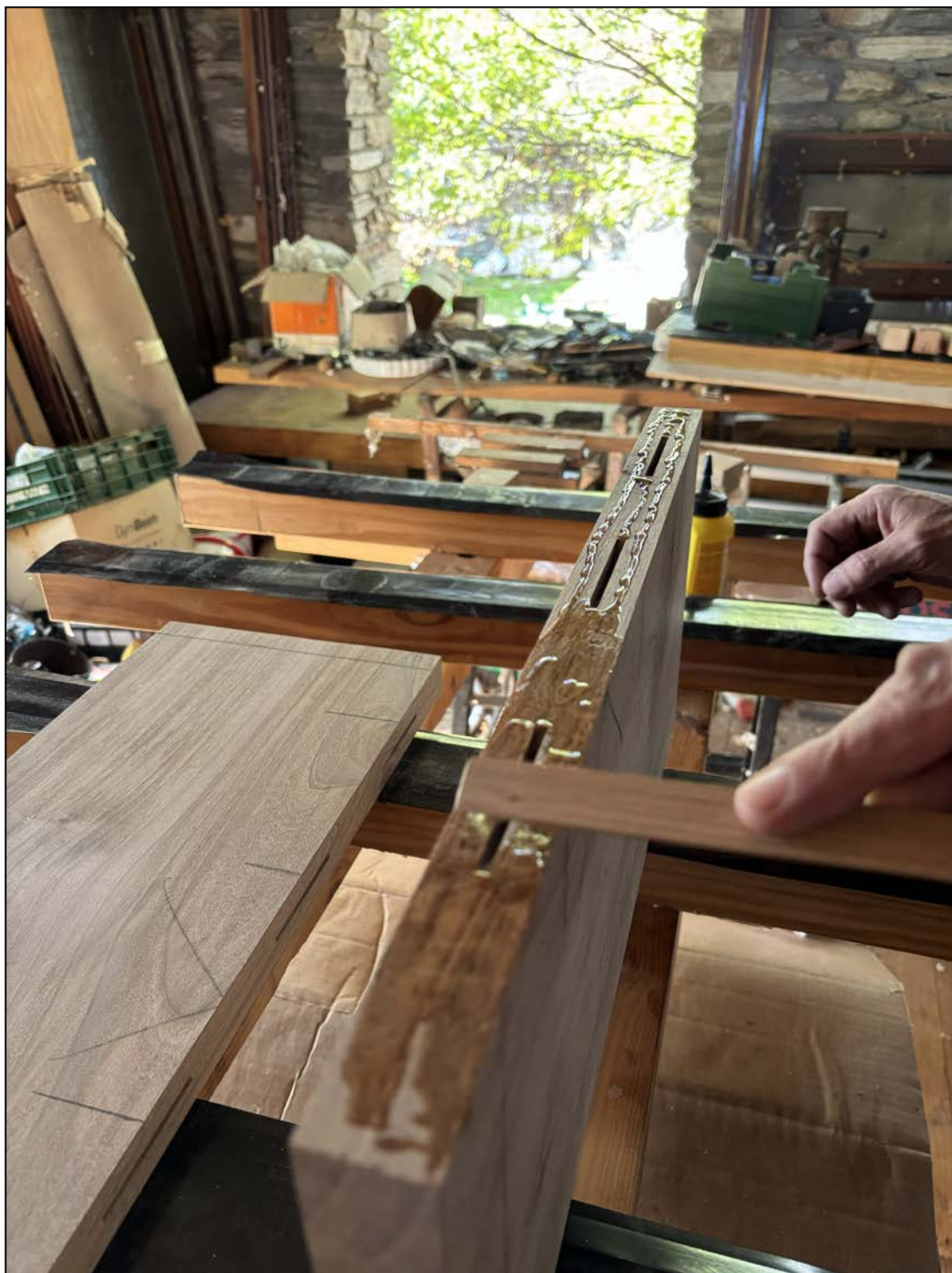
Εικόνα 104. Επάλειψη κόλλας (Φωτ. Προσωπικό αρχείο).
