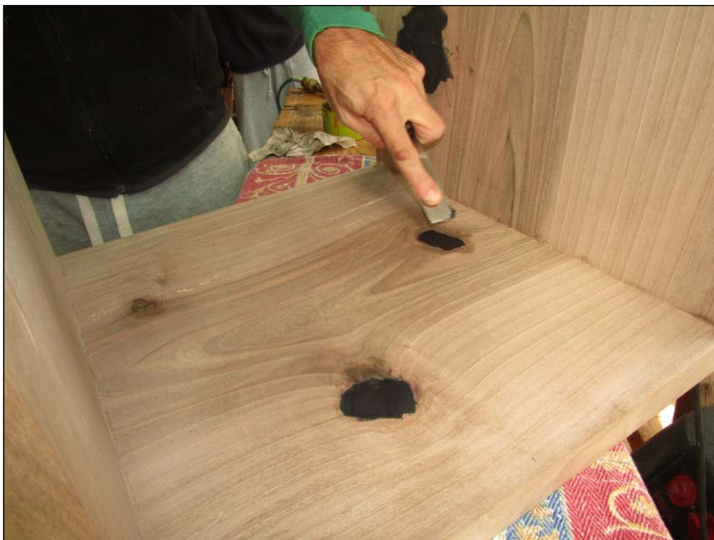
Εικόνα 123. Κάλυψη μικροοπών με μαύρο στόκο (Φωτ. Προσωπικό αρχείο).
