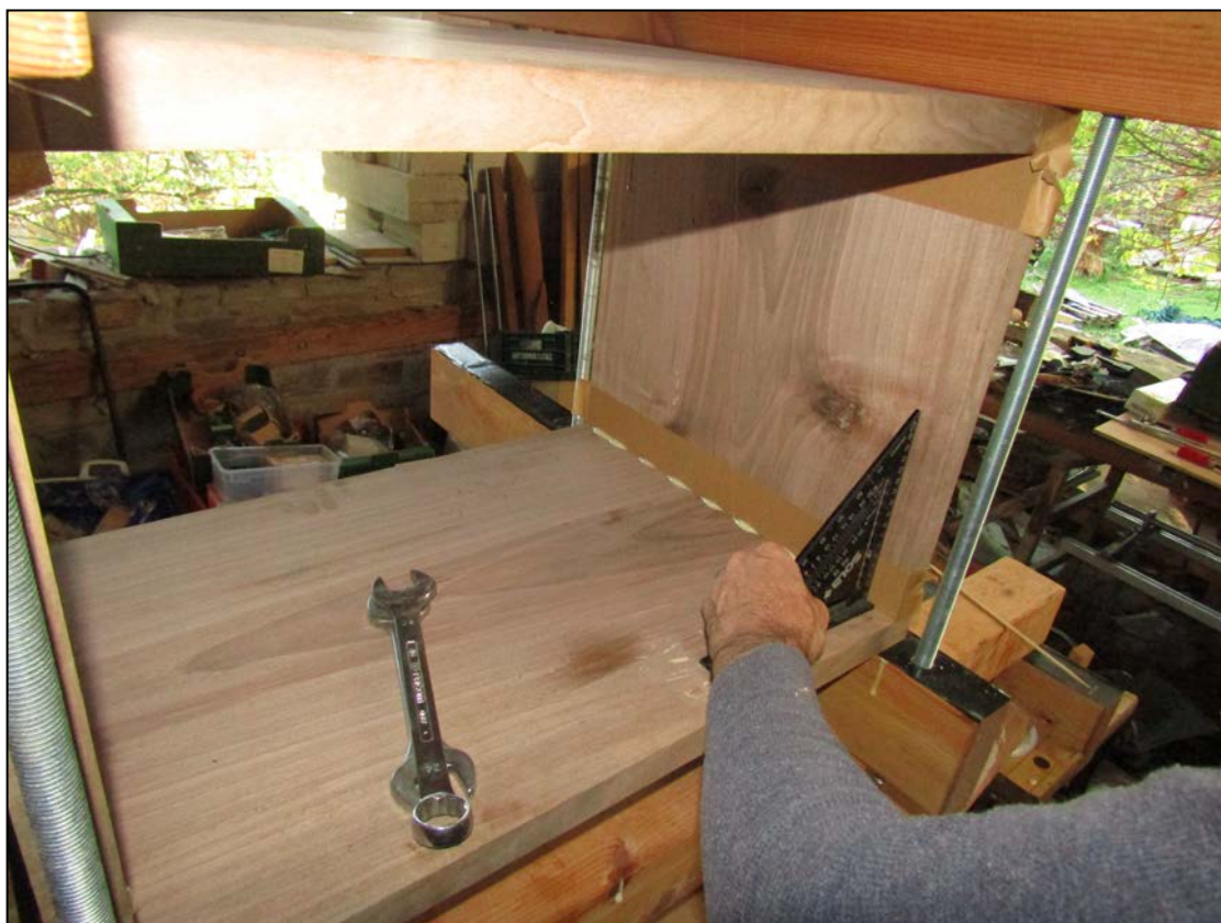
Εικόνα 118. Έλεγχος καθετότητας των γωνιών του κουτιού (Φωτ. Προσωπικό αρχείο).
