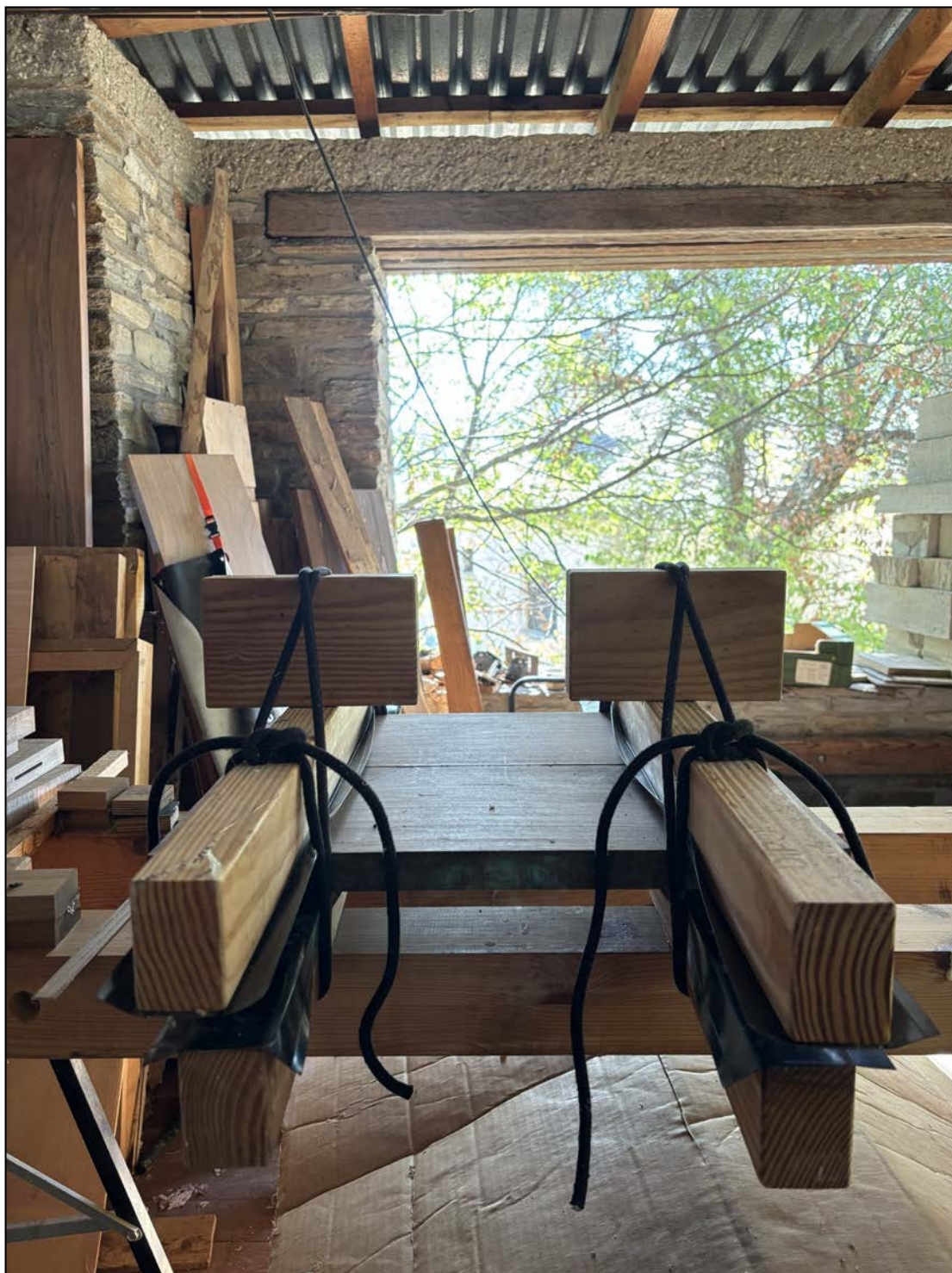
Εικόνα 107β. Ιαπωνική τεχνική σύσφιξης τεμαχίων (Φωτ. Προσωπικό αρχείο).
