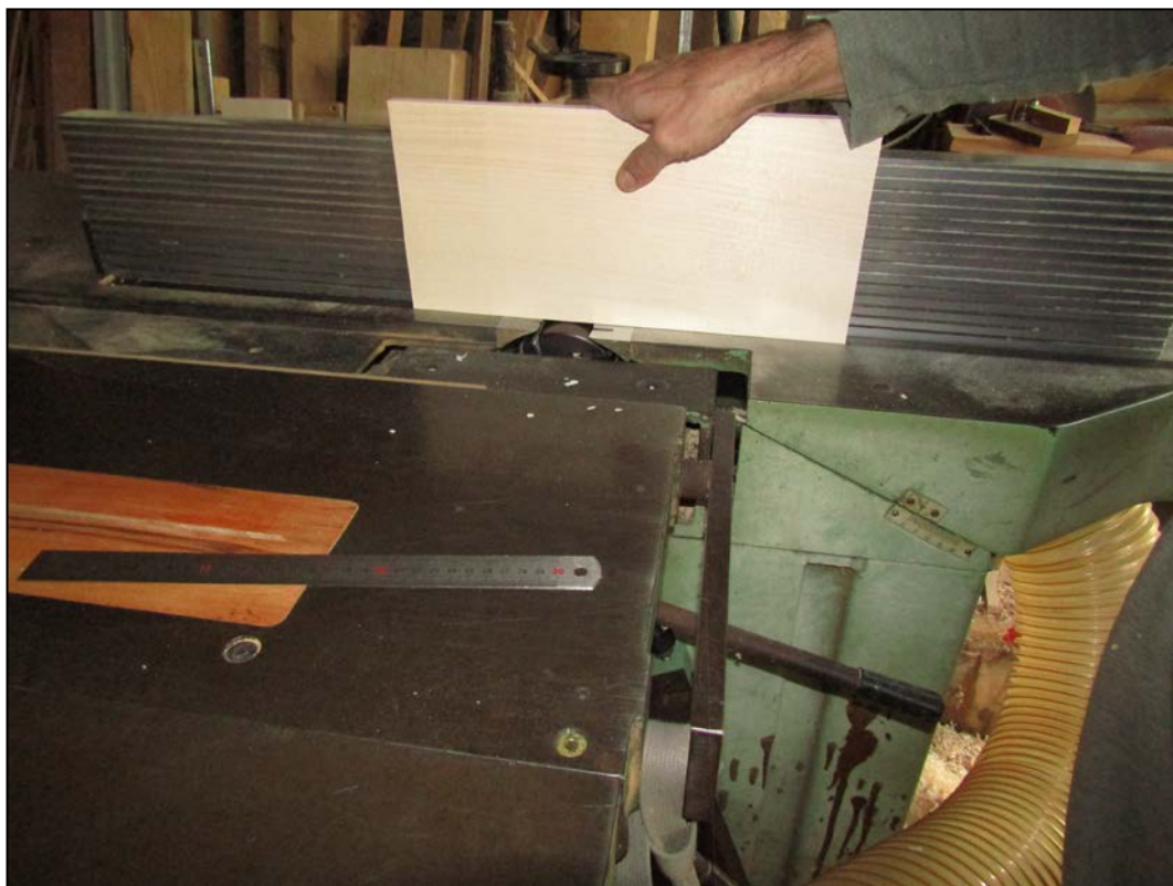
Εικόνα 137. Πλάνισμα, κατά πλάτος, τεμαχίων των συρταριών (Φωτ. Προσωπικό αρχείο).
