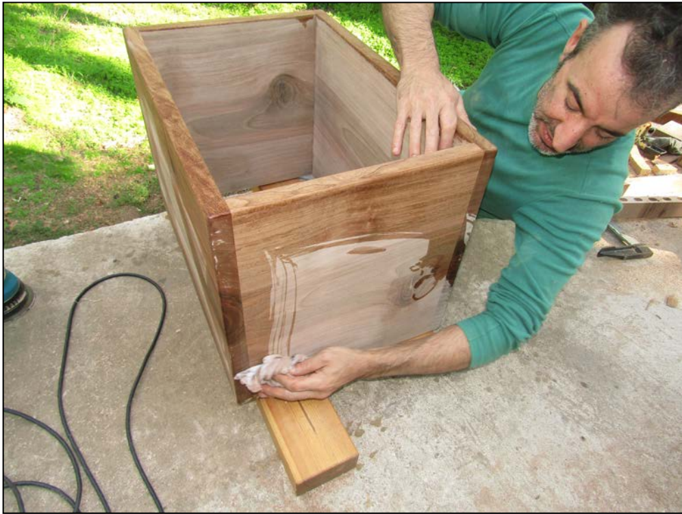
Εικόνα 68. Διαβροχή ξύλινης επιφάνειας (Φωτ. Προσωπικό αρχείο).
