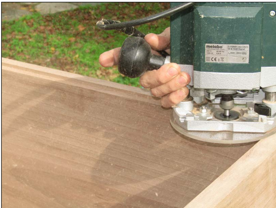
Εικόνα 126α. Διαμόρφωσή της πατούρας, με ρούτερ (Φωτ. Προσωπικό αρχείο).
