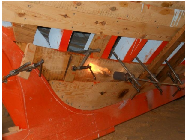
Εικόνα 6.191: Το τελευταίο σανίδι ονομάζεται ντουρέλο και το αμέσως επόμενο καβαλάρης.
