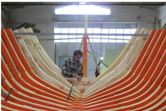
Εικ. 6.5.83: Τοποθέτηση τάκου νομέα στην πλώρη του τρεχαντηριού.
