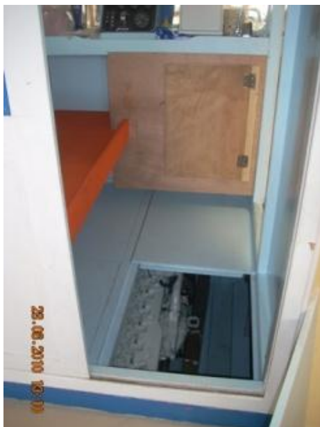
Εικόνα 6.267: Το εσωτερικό της γέφυρας του σκάφους, κατασκευασμένο εξ' ολοκλήρου από κόντρα πλακέ θαλάσσης, ενώ στο εσωτερικό του δαπέδου διακρίνεται η μηχανή του.
