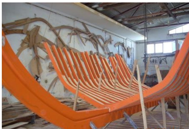
Εικ. 6.5.65: Διακρίνεται ο ασός (λούκι) στο πλωριό ποδόσταμο και οι μεσαίες πόστες του σκάφους.
