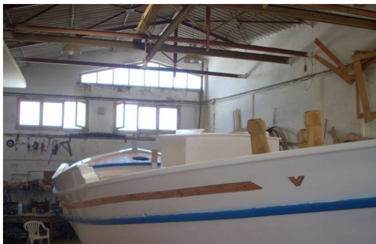
Εικόνα 6.261: Διακρίνεται η καμπυλότητα από την πλώρη ως την πρύμη του τρεχαντηριού, απαραίτητη προδιαγραφή για καΐκα τύπου τρεχαντηριού.
