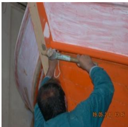
Εικόνα 6.245: Το γέμισμα μεταξύ των αρμών των σανιδιών με φυτίλι γίνεται με τη χρήση της ματσόλας.
