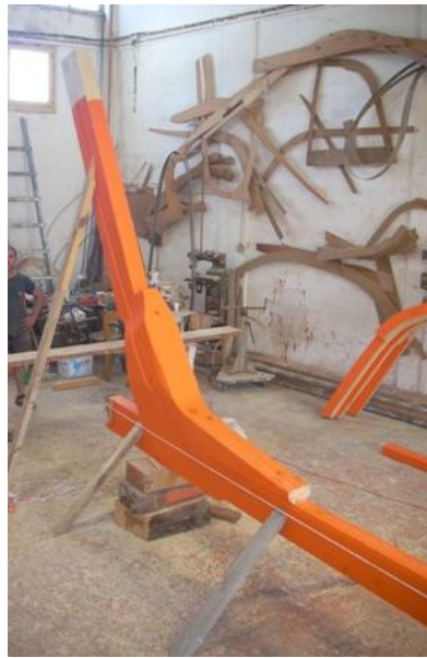
Εικ. 6.5.36: Το πρυμό ποδόσταμο και ο σκορπιός τοποθετημένα στα βάζα επαλειμμένα με αστάρι.
