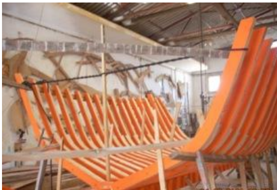
Εικ. 6.5.71: Τα οριζόντια στοιχεία που διατρέχουν τον σκελετό, οι λεγόμενες φούρμες καρφώνονται προσωρινά, κατόπιν της τοποθέτησης των μεσαίων νομέων με σκοπό να δώσουν το τελικό σχήμα της γάστρας και να δημιουργηθούν οι τελευταίοι νομείς του σκάφους, τα λεγόμενα γεμίσματα ή ριπίδια.
