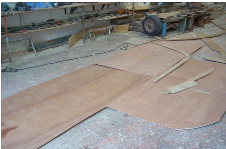
Εικ. 6.5.48: Πλάκες κόντρα πλακέ θαλάσσης πάχους όπου θα δημιουργηθούν τα χνάρια του καϊκιού.
