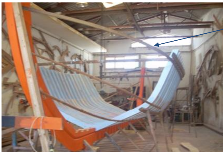
Εικ. 6.5.72: Πρώτο στάδιο, καρφώνονται δυο πήχεις στο επάνω μέρος των νομέων και στερεώνονται στο πλωριό ποδόσταμο.
