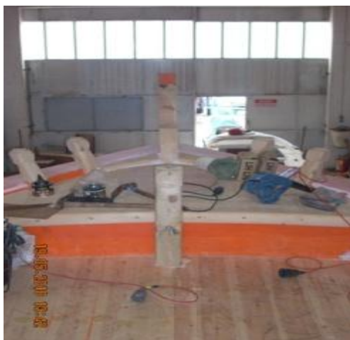
Εικόνα 6.195: Διακρίνεται η κεντρική μπίντα και οι τέσσερις μικρότερες που πλαισιώνουν την κούμιζα της πλώρης.
