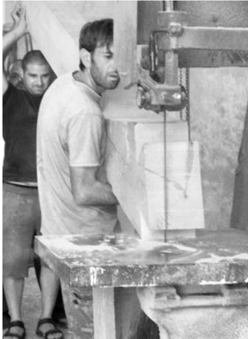
Εικ. 6.5.16: Η κατάλληλη κλίση που θα δοθεί στο κορμοτεμάχιο κατά την κοπή του και η σταθερότητα στις κινήσεις είναι απαραίτητες ενέργειες για να δοθούν οι απαιτούμενες διαστάσεις και η απαιτούμενη μορφή του ποδοστάματος.
