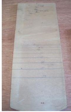
Εικ. 6.5.46: Ένα από τα βασικά εργαλεία του παραβομαραγκού για την σχεδίαση των νομέων είναι η καρένα. Όσο αυξάνεται ο αριθμός στη θέση της καρένας, τόσα περισσότερα νερά τραβά ένα σκάφος.
