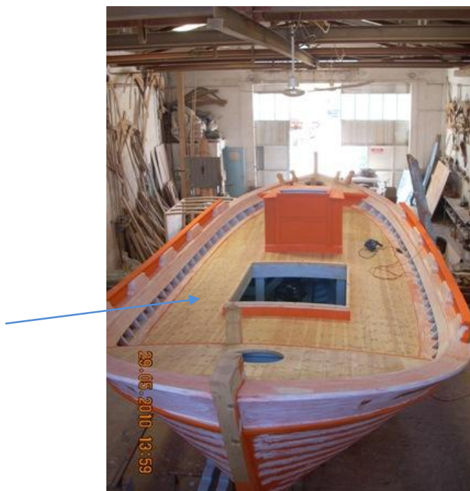
Εικόνα 6.190: Το κατάστρωμα του τρεχαντηριού. Έχει επενδυθεί όλο το κατάστρωμα και οι κούμιζες του, έχει στοκαριστεί και είναι έτοιμο για το τελικό χρώμα.
