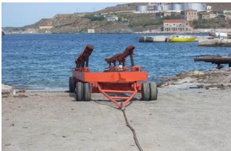
Εικ. 5.6.1.3: Το σημείο ανέλκυσης και καθέλκυσης του ταρσανά και το τρέιλερ της επιχείρησης.
