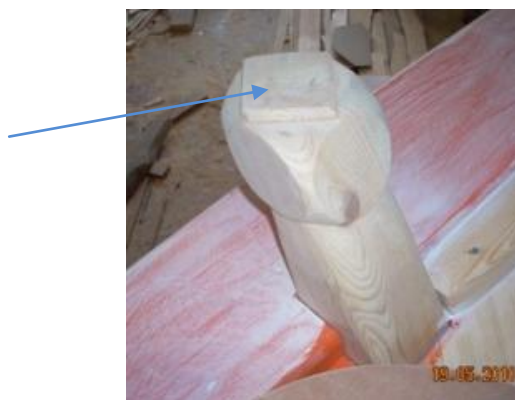
Εικόνα 6.196: Το ρομβικό σχήμα που διακρίνεται στην κορυφή της μπίντας ονομάζεται παστέλι.
