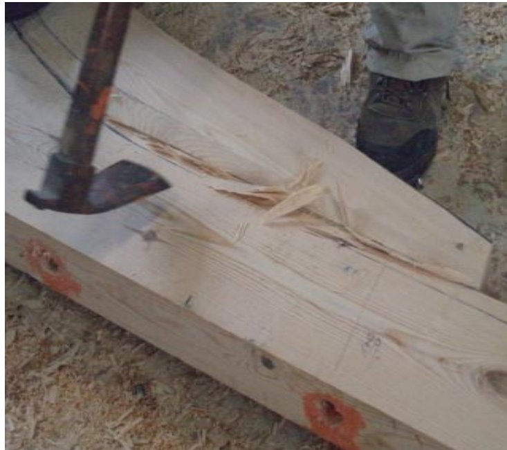
Εικ. 6.5.42: Το σκεπάρι είναι το βασικότερο εργαλείο του караβομαραγκού. Με σταθερά και δυνατά πελεκήματα δημιουργείται ο ασός.
