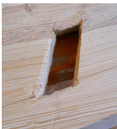
Εικόνα 6.171: Τα άκρα της εγκοπής θα διαμορφωθούν έτσι, ώστε να εισχωρήσει σε αυτήν το φυτίλι του καλαφατίσματος και να στεγανοποιήσει το σημείο αυτό του σκάφους.
