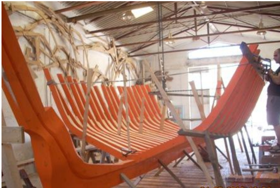
Εικ. 6.5.70: Οι φούρμες συγκρατούν όλο το σκαρί, οριοθετούν τις αποστάσεις μεταξύ των νομέων και κρατούν αμετάβλητες τις αποστάσεις τους κατά την διάρκεια της κατασκευής του σκάφους.
