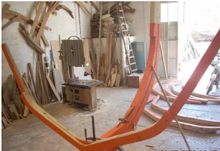
Εικ. 6.5.37: Πλωριό ποδόσταμο και ακράπι, στην εικόνα διακρίνεται επίσης και ο τελευταίος νομέας από τους μεσαίους νομείς του τρεχαντηριού.
