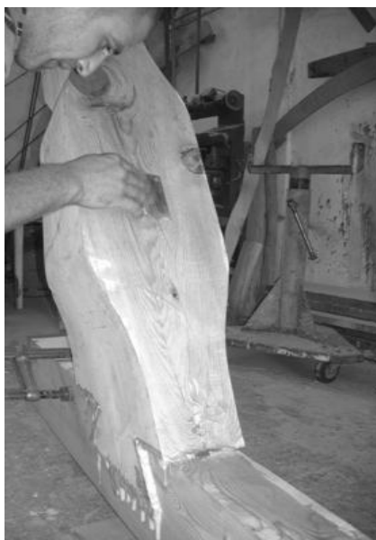
Εικ. 6.5.31: Το πρυμνό ποδόσταμο ενωμένο με την καρένα επαλείφεται με τις απαραίτητες συγκολλητικές ουσίες και λειαίνεται ώστε να υποδεχτεί στο εσωτερικό του μέρος τον σκορπιό του σκάφους.
