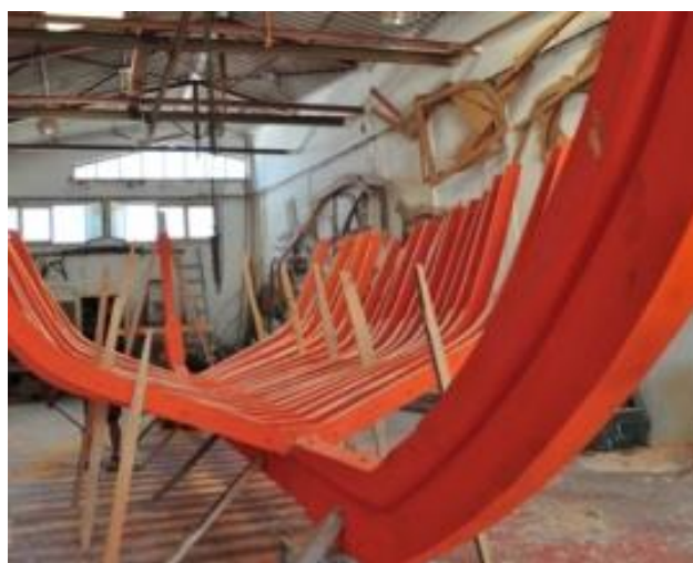
Εικ. 6.5.66: Ο σκελετός του τρεχαντηριού από την μεριά της πλώρης. Διακρίνεται ο ασός μεταξύ πλωριού ποδοστάματος και ακραπιού, καθώς και στην καρένα του.
