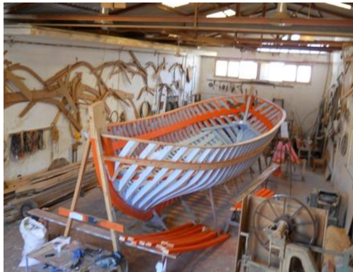
Εικόνα 6.146: Στο επάνω μέρος των νομέων και περιμετρικά όλου του τρεχαντηριού διακρίνουμε το κουρζέτο, την τσάπα η οποία βρίσκεται στο εξωτερικό περίβλημα του σκάφους και στο εσωτερικό του το λεγόμενο αστάρι, το οποίο διατρέχει ομοίως όλο το μήκος του και αποτελεί την βάση των καμαριών της κουβέρτας.
