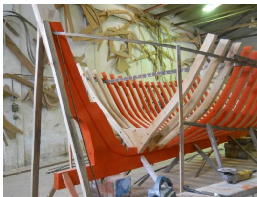
Εικ. 6.5.87: Οι «μονοί» νομείς της πρύμης τοποθετημένοι και στη μέση οι τάκοι τους.
