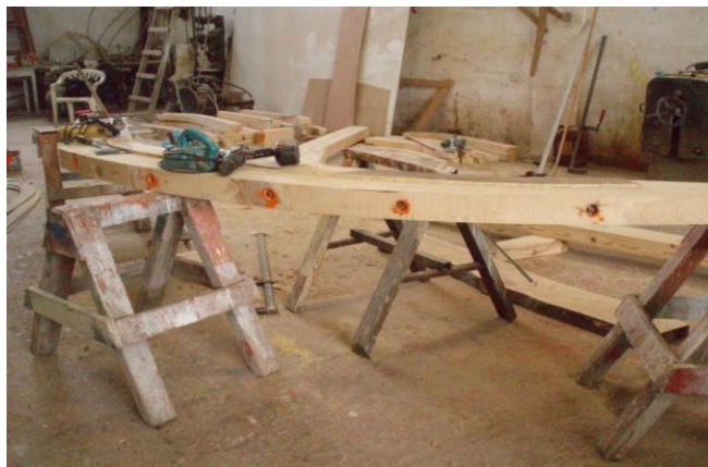
Εικ. 6.5.34: Σύνδεση πλωριού ποδόσταμου και ακραπιού με συγκολλητικές ουσίες και τζαβέτες.
