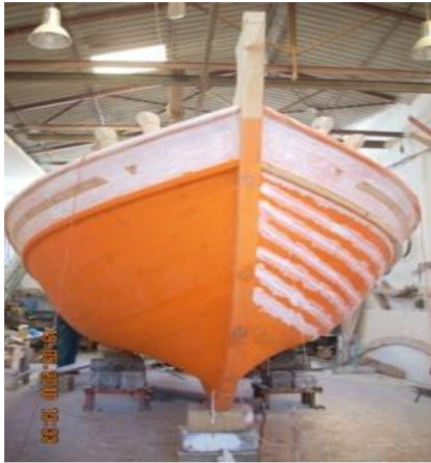
Εικόνα 6.249: Μετά από τη διαδικασία του καλαφατίσματος στο σημείο των καλαφατισμένων αρμών, θα τοποθετηθεί στόκος.
