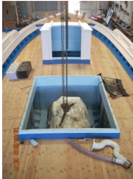
Εικόνα 6.238: Τοποθέτηση μηχανής τρεχαντηριού.
