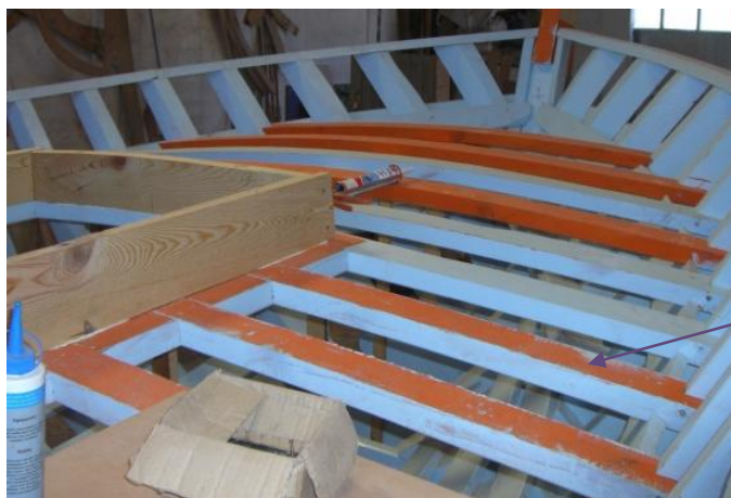
Εικόνα 6.164: Τα κοντοκάμαρα ή μισοκάμαρα στην δεξιά πλευρά του καταστρώματος.
