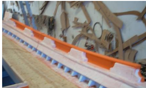
Εικόνα 6.182: Διακρίνονται οι πέντε τάκοι του καϊκιού και η πέλα του τρεχαντηριού.
