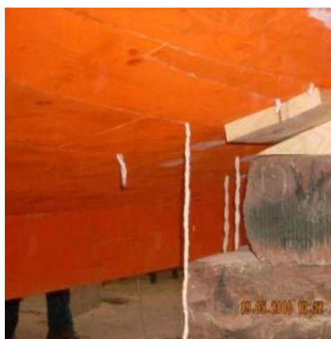
Εικόνα 6.248: Το φυτίλι εισχωρεί στους αρμούς σε σημείο κορεσμού και η περιττή όλη αφαιρείται με τη χρήση των κοπιδιών.
