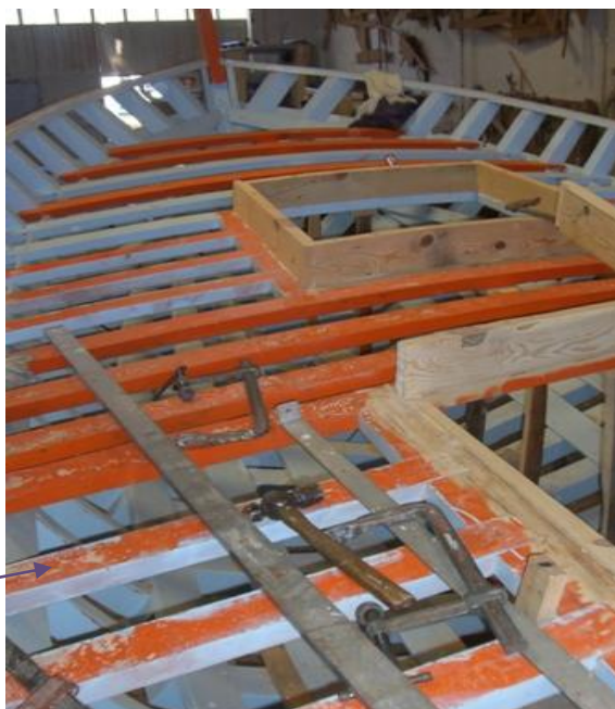
Εικόνα 6.165: Τα κοντοκάμαρα ή μισοκάμαρα στην αριστερή πλευρά του καταστρώματος.
