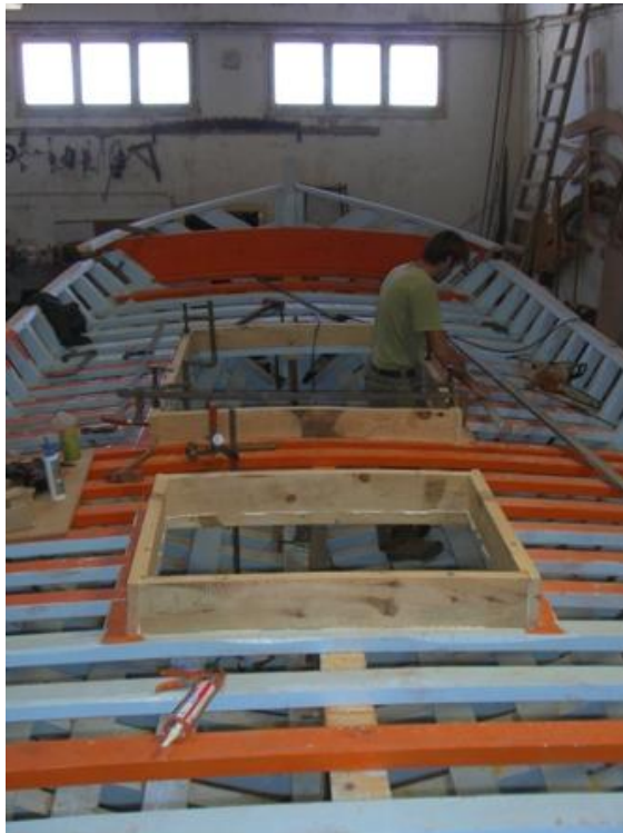
Εικόνα 6.166: Το κατάστρωμα του τρεχαντηριού πριν το πέτσωμα του, αποτελούμενο από όλα τα καμάρια, τα δύο κουβούσια και τις καδένες του.
