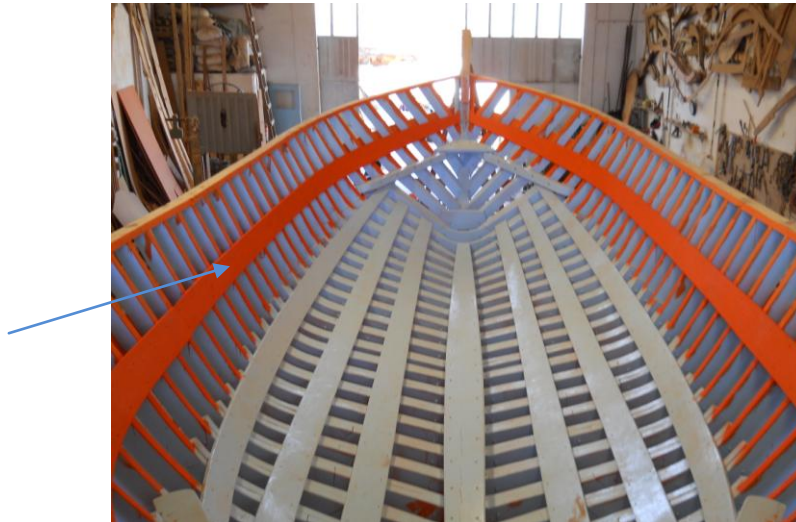
Εικόνα 6.145: Το αστάρι βρίσκεται πάνω από τις αστραγαλιές και διατρέχει όλο το μήκος του σκάφους στο εσωτερικό του. Αποτελεί τη βάση για την τοποθέτηση των καμαριών της κουβέρτας και διατηρεί αμετάβλητες τις αποστάσεις των νομέων.
