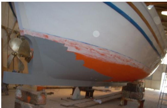
Εικόνα 6.258: Το γκρι χρώμα που διακρίνεται στην εικόνα είναι η παλάμη του σκάφους.
