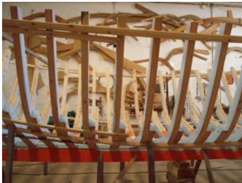
Εικ. 6.5.75: Οι φούρμες στο επάνω μέρος τοποθετούνται τελευταίες σε σειρά.
