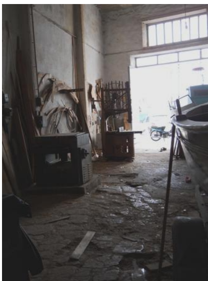
Εικ. 5.6.3.4: Ο εσωτερικός χώρος του ναυπηγείου. Στο βάθος διακρίνεται η πριονοκορδέλα και μπροστά ο ξεχονδριστήρας του ταρσανά.
