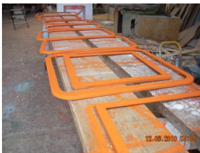
Εικόνα 6.229: Τα τελάρα των παραθύρων της γέφυρας. Το πορτοκαλί χρώμα που διακρίνεται ονομάζεται αστάρι ή μίνιο.
