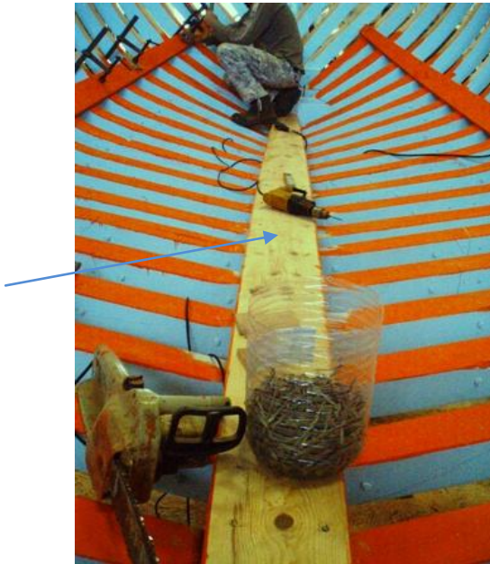
Εικ. 6.5.99 : Το μεσαίο μαδέρι κάθετο στους νομείς ονομάζεται σωτρόπι. Ενώνει τους νομείς με την καρένα του σκάφους.
