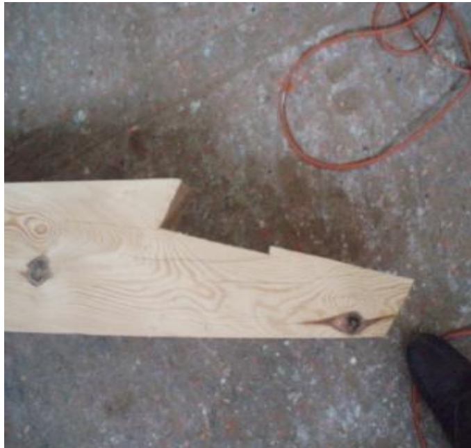
Εικ. 6.5.28: Δημιουργία κατάλληλης εγχοπής στην καρένα του σκάφους για την ένωσή της με το πλώριο ποδόσταμο.
