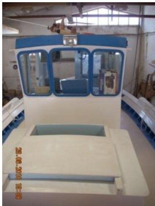
Εικόνα 6.264: Η γέφυρα στην τελική της μορφή και το ταμπόκιο της εισόδου στο αμπάρι.
