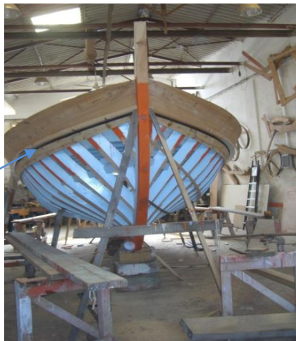
Εικόνα 6.173: Η μαύρη λωρίδα που διακρίνεται στην εικόνα χρησιμοποιείται από τον ξυλοναυπηγό σαν οδηγός για να δώσει την απαιτούμενη μορφή στο ζωνάρι του τρυπητού. Στην γλώσσα της ξυλοναυπηγικής χρησιμοποιείται η έκφραση «το ισοδιάγραμμα του ζωναριού», δηλαδή αν το ζωνάρι ακολουθεί την μορφή που απαιτείται.
