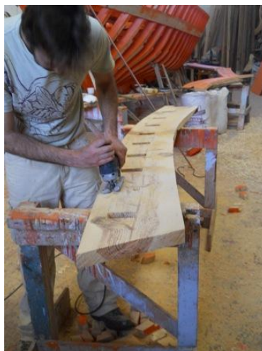
Εικόνα 6.168: Ο караβομαραγκός αφαιρεί με τη χρήση της σέγας την απαιτούμενη ξύλινη ύλη, για να δημιουργηθούν οι εγκοπές του στοιχείου του τρυπητού.
