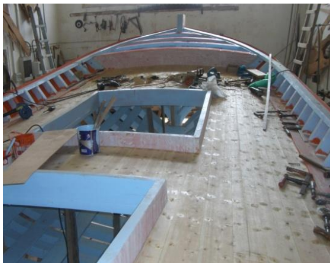
Εικόνα 6.185: Η κουβέρτα του σκάφους από σανίδια πεύκου Μυτιλήνης, τοποθετημένα κατά μήκος του σκάφους.
