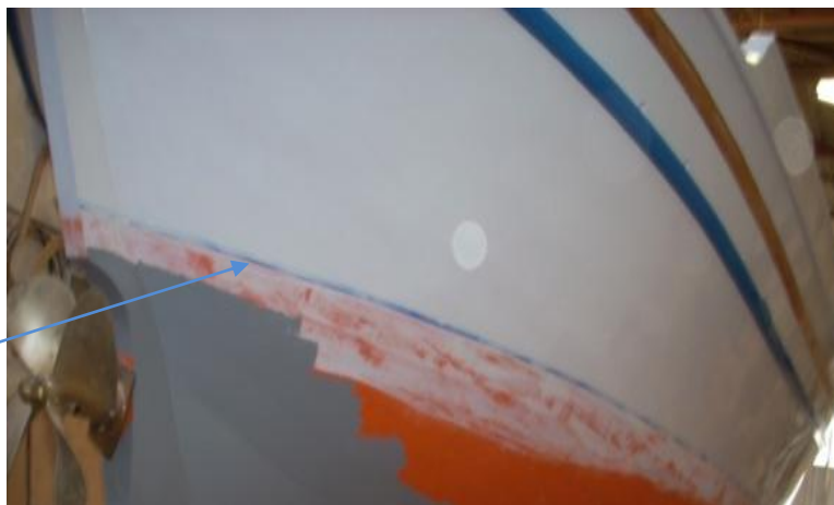
Εικόνα 6.257: Η μπλε αχνή γραμμή που διακρίνεται στη γάστρα του σκάφους ονομάζεται γραμμή της ισάλου.
