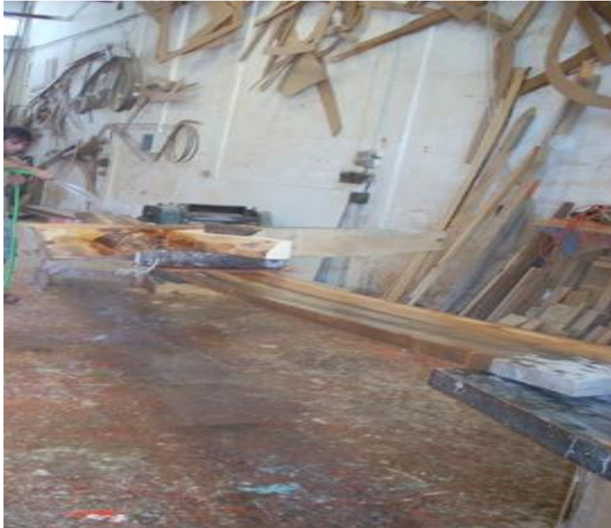
Εικ. 6.5.69: Τα μαδέρια που θα αποτελέσουν τις φούρμες περιβρέχονται με νερό και με το βάρος από κορμούς ο καραβομαραγκός θα δώσει μια μικρή καμπυλότητα στα στοιχεία, ένας παραδοσιακός τρόπος καμπύλωσης του ξύλου. Τα δομικά αυτά στοιχεία θα χρησιμοποιηθούν για την δημιουργία των φουρμών.
