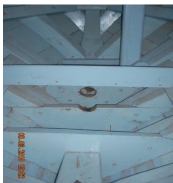
Εικόνα 6.218: Εσωτερικό της πρύμης, έχει διαμορφωθεί κατάλληλη οπή για τον άξονα προπέλας.
