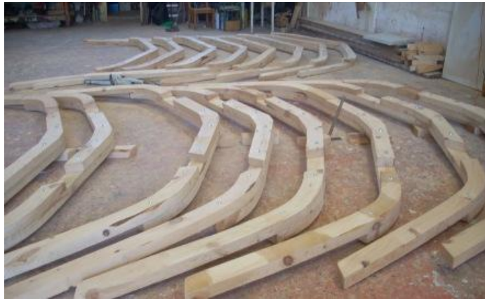
Εικ. 6.5.61: Μαντάλι, έδρα και ποδάρι κάθε νομέα έχει ενωθεί και θα τοποθετηθούν στις κατάλληλες εγχοπές της καρένας.
