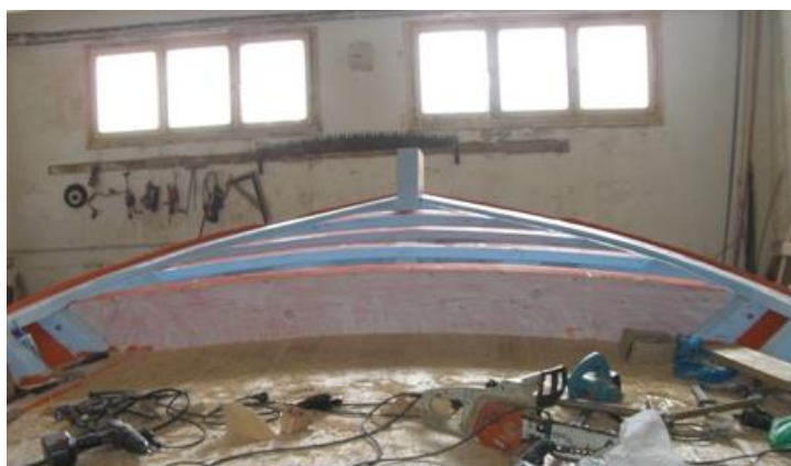
Εικόνα 6.187: Η κούμιζα της πρύμης πριν πετσωθεί.
