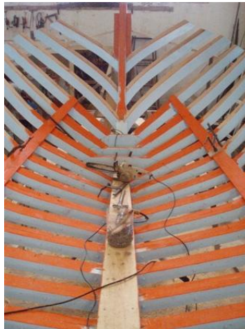
Εικ. 6.5.100: Η πρώτη δεξιά και η πρώτη αριστερή στραγαλιά του τρεχαντηριού, από τις έξι συνολικά στο εσωτερικό του σκελετού.
