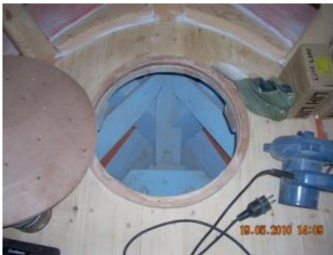
Εικόνα 6.189: Η κούμιζα της πλώρης, διακρίνεται στο εσωτερικό η φουρνιστή και τα ντουφέκια. Το καπάκι της είναι κατασκευασμένο από κόντρα πλακέ θαλάσσης (αντικολλητό).
