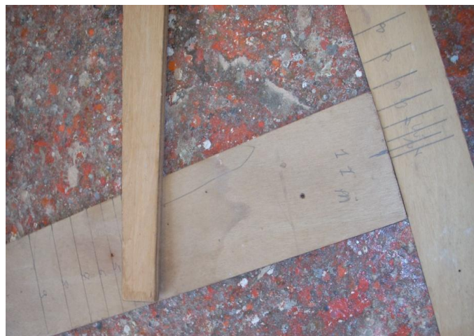
Εικ. 6.5.45: Το τραμπουκέτο και η καρένα που θα χρησιμοποιηθούν για τον σχεδιασμό των χναριών των νομέων του τρεχαντηριού.
