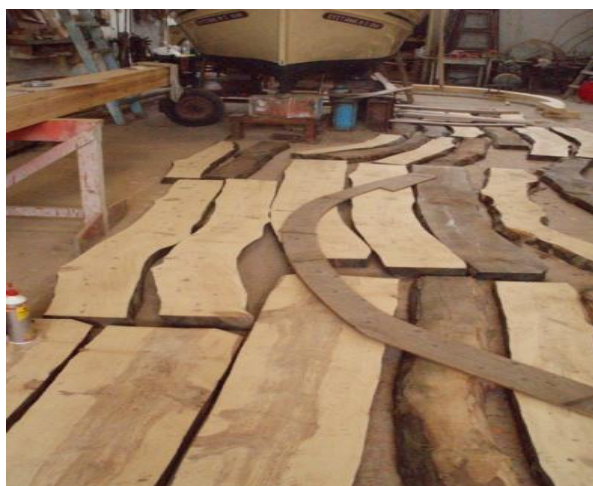
Εικ. 6.5.55: Κορμοτεμάχια με υπερδιάσταση που θα αποτελέσουν τους νομείς του σκάφους.
