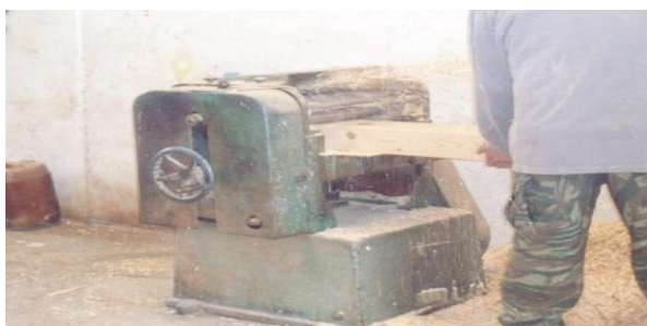
Εικ. 6.5.1, Εικ. 6.5.2, Εικ. 6.5.3: Διαμόρφωση μαδεριού που θα αποτελέσει την καρένα του τρεχαντηριού στον ξεχονδριστήρα του ταρσανά. Θα δοθούν οι τελικές διαστάσεις πλάτους και φάρδους της καρένας.
