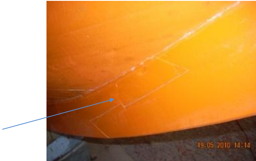
Εικόνα 6.251: Σύνδεση, παρέλα ποδόσταμου και καρένας.
