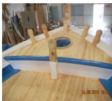
Εικόνα 6.260: Τελικό χρώμα κουπαστής, κούμζας και καδένας.
