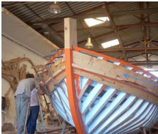
Εικόνα 6.175: Τοποθέτηση μαδεριού στην δεξιά πλευρά της πλώρης του τρεχαντηριού, του λεγόμενου μπούρδου.
