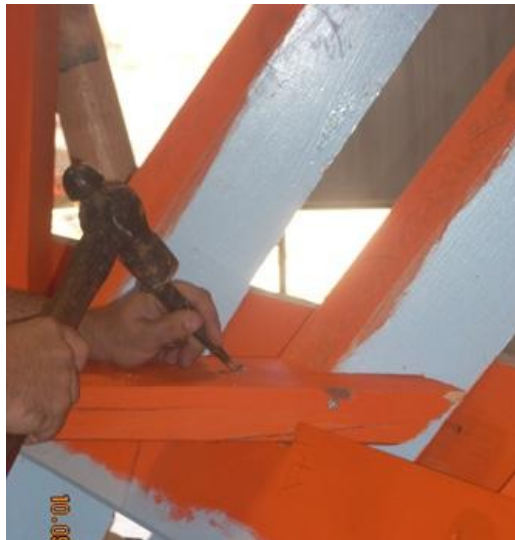
Εικόνα 6.147: Με το σφυρί και τον ζουμπά τα καρφιά εισχωρούν βαθύτερα στα καμάρια του τρεχαντηριού.
