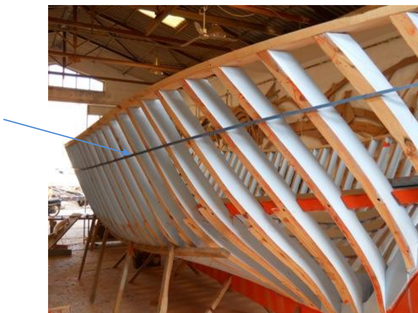
Εικόνα 6.135: Ο μπλε πήχης που διακρίνεται στην εικόνα αντιστοιχεί στην θέση του πάνω μέρους της τσάπας και εκεί όπου θα πατήσει το τρυπητό του τρεχαντηριού. Επίσης, θα καθορίσει το ύψος του παραπέτου.
