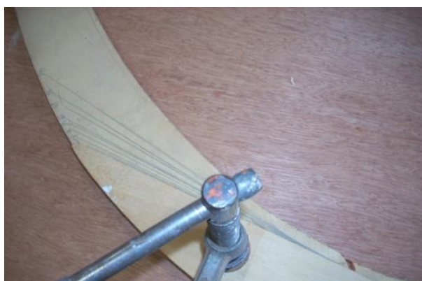
Εικ. 6.5.49: Οι σχεδιασμένες ευθείες που διακρίνονται στο μαντάλι του χναριού θα δώσουν την καμπυλότητα του νομέα.
