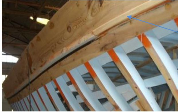
Εικόνα 6.174: Το κομμάτι ζύλου μετά την μαύρη λωρίδα, ονομάζεται σιγούντο του τρυπητού.
