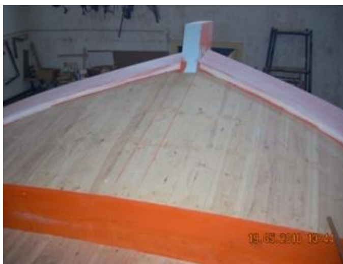
Εικόνα 6.188: Η πρύμη, με τα κάθετα σανίδια στο πέτσωμά της, πριν σχεδιαστεί η κούμιζα της πρύμης.
