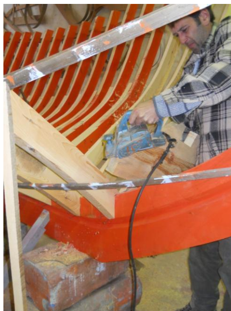
Εικ. 6.5.82: Ροκάνισμα τάκου ριπιδιού.
