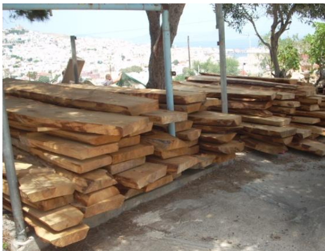
Εικ.5.6.2.3: Η σκιά που προσφέρουν τα πεύκα και τα πηχάκια μεταξύ των κορμοτεμαχίων εξασφαλίζουν την φυσική ξήρανση των κορμών.
