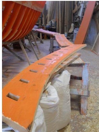
Εικόνα 6.169: Στην εικόνα διακρίνονται τα στοιχεία που θα αποτελέσουν το τρυπητό του σκάφους.
