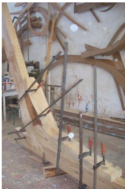
Εικ. 6.5.33: Συγκράτηση με σφικτήρες της καρένας, ποδόσταμου και σκορπιού για πλήρη συγκόλληση και ενοποίησής τους.
