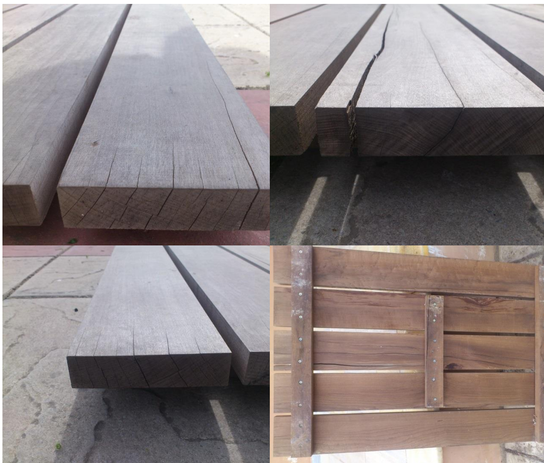
Εικόνα 8.3 MenzHolz Deck σφάλματα.
