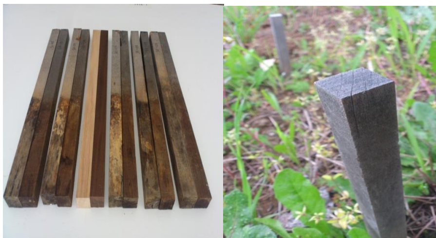
Εικόνα 8.1 Δείγματα σε επαφή με το έδαφος αλλοιώσεις – δείγμα MenzHolz.
