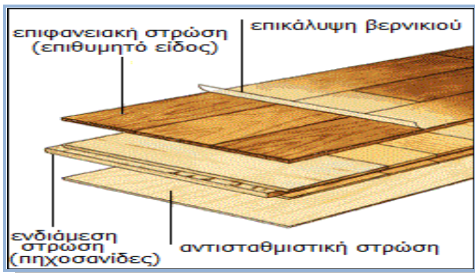
Εικόνα 3.20: Τυπική δομή τριστρωμης σανίδας
