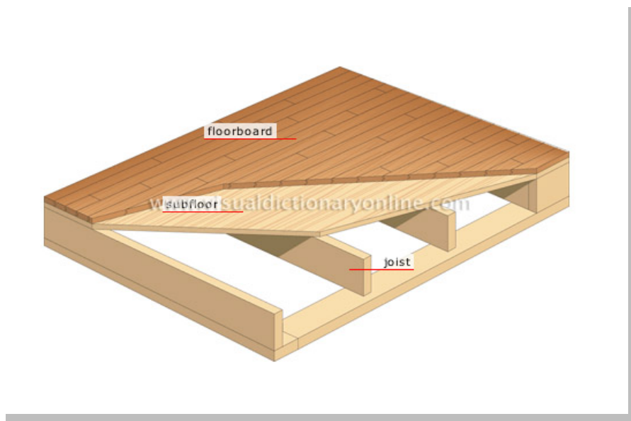
Εικόνα 3.31: Τοποθέτηση ξυλοτεμαχίων κάθετα με τη φορά των δοκών του υποστρώματος
