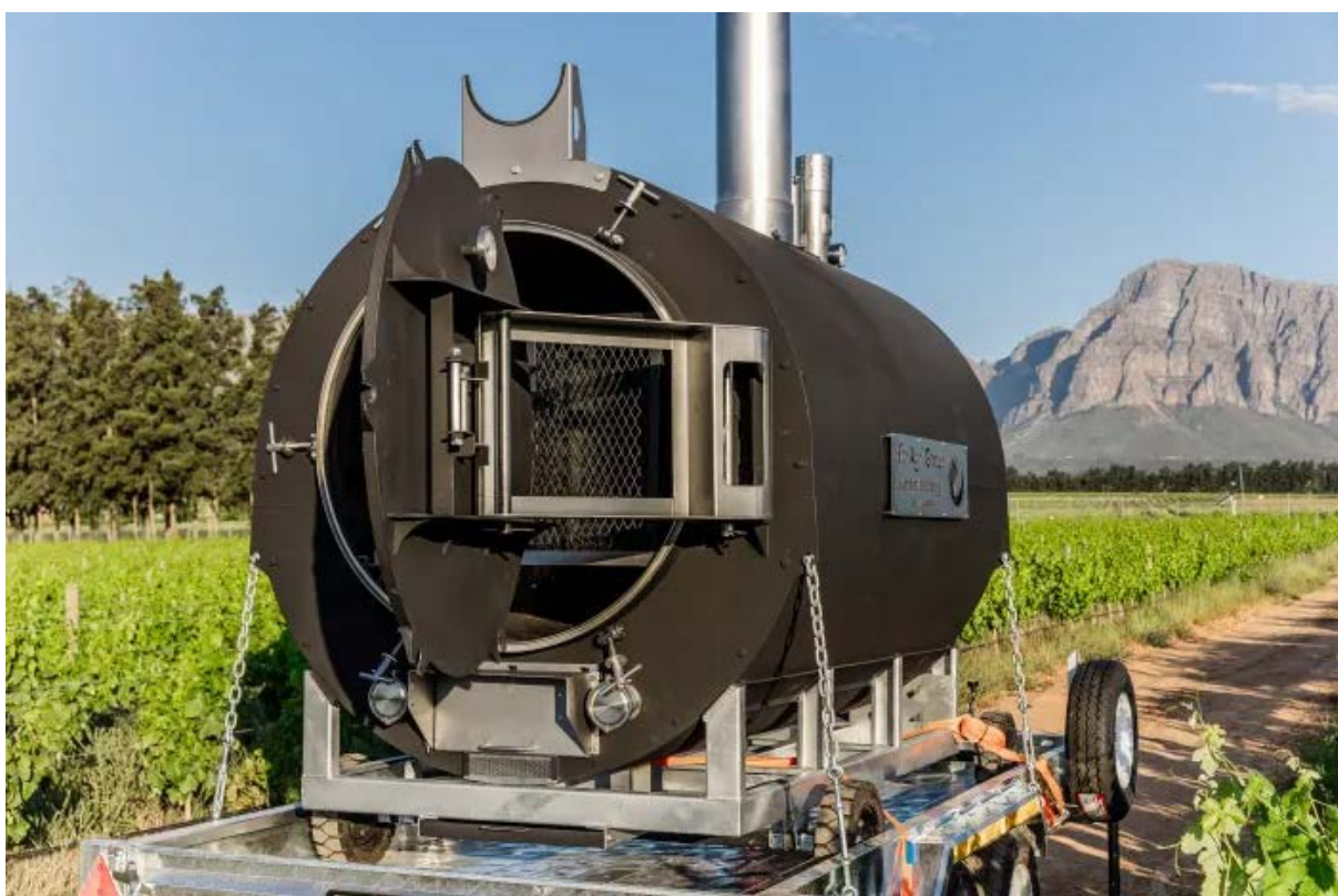
Εικόνα 6.24: Πολύ μικρής κλίμακας, φορητός κλίβανος πυρόλυσης, της εταιρίας ΒΚΙ.
