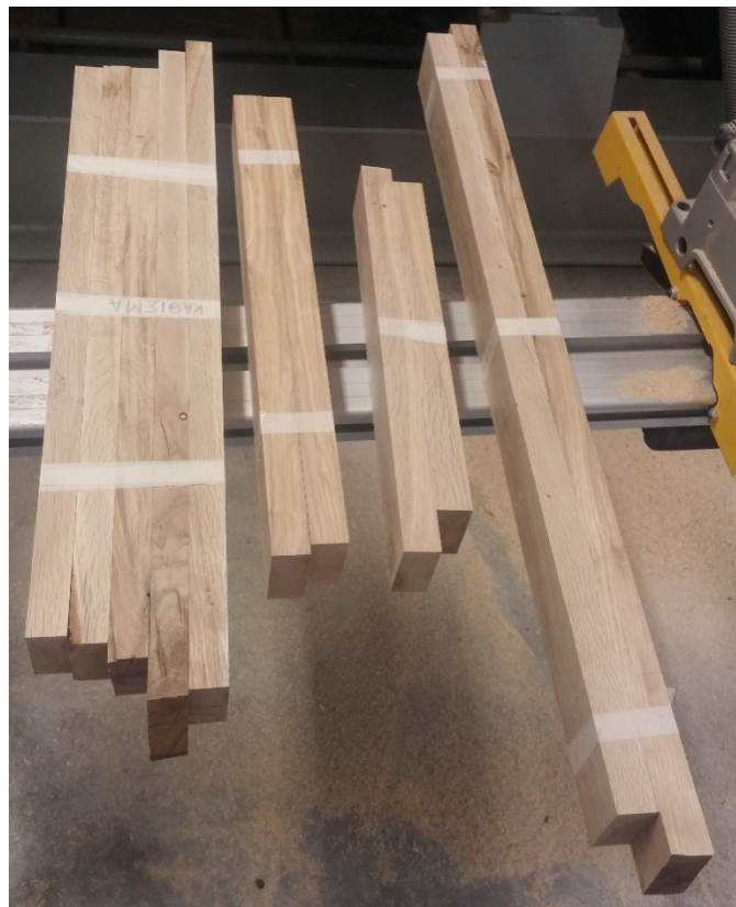
Εικόνα 6.13: Ξυλοτεμάχια κομμένα στα επιθυμητά μήκη, πλανισμένα με λείες επιφάνειες.
