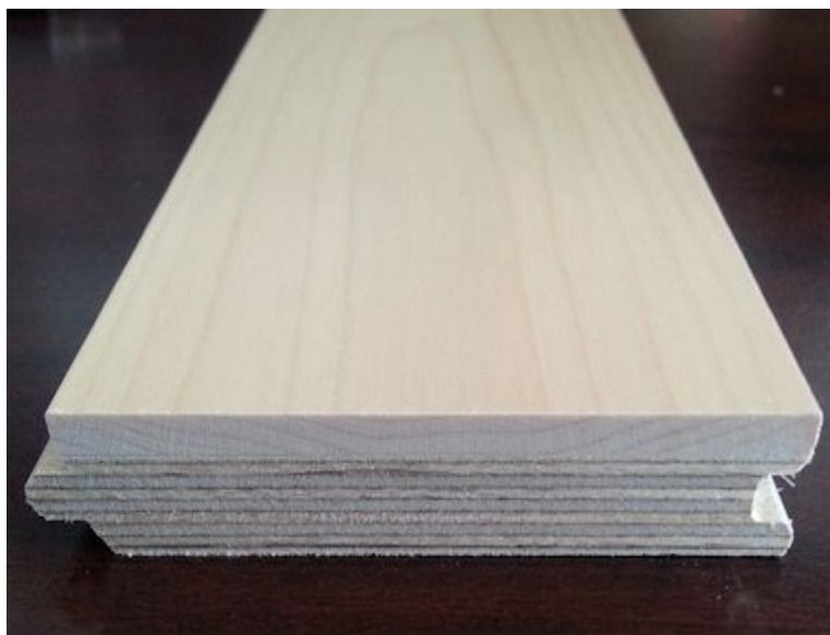
Εικόνα 4.20: Τεμάχιο τρικολλητού δαπέδου το οποίο δεν έχει υποστεί διαδικασία φινιρίσματος
