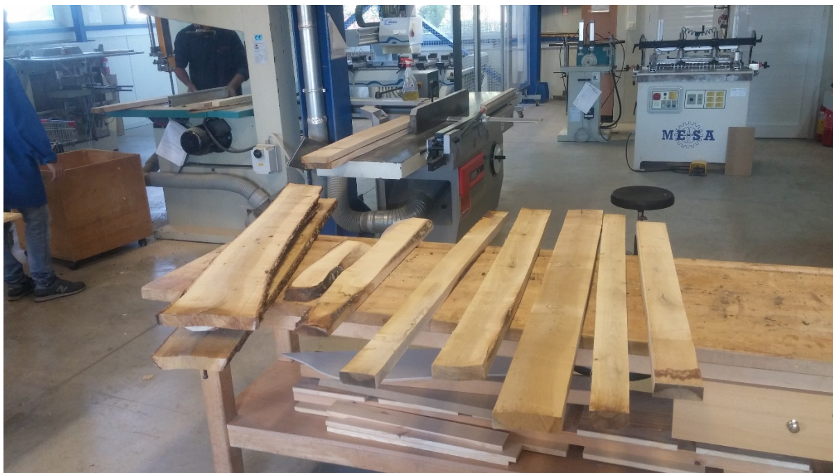
Εικόνα 6.11: Αριστερά φαίνονται δοκίμια απαρύφωτα και δεξιά παρυφωμένα, έτοιμα για εφαρμογή σε διάφορες κατασκευές.
