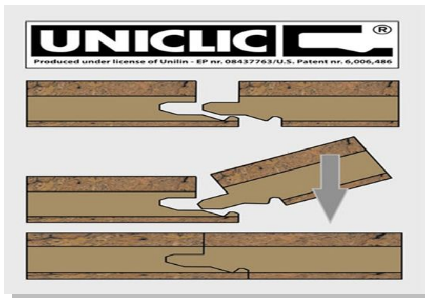
Εικόνα 4.18: Εξελιγμένος τύπος κουμπώματος uniclic
