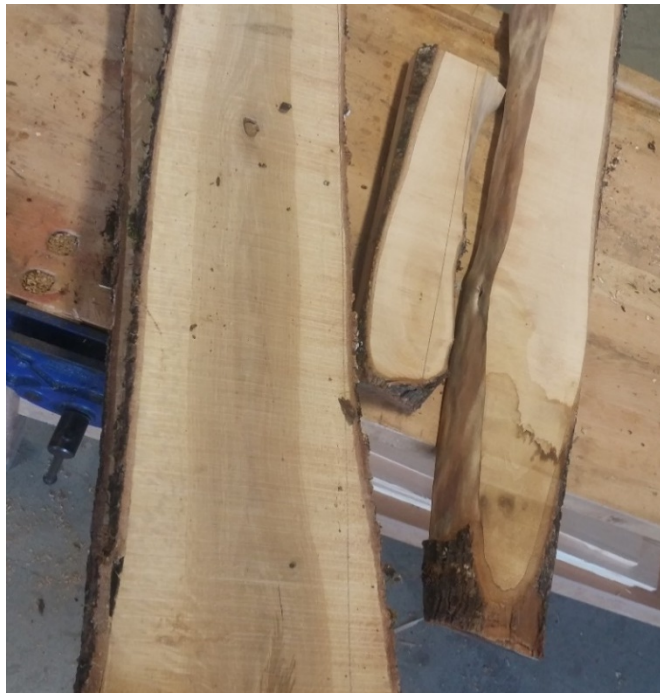
Εικόνα 6.9: Μέτρηση και χάραξη των δοκιμίων για την παρύφωσή τους με τρόπο τέτοιο ώστε να επιτυγχάνεται βέλτιστη αξιοποίηση ξυλείας.
