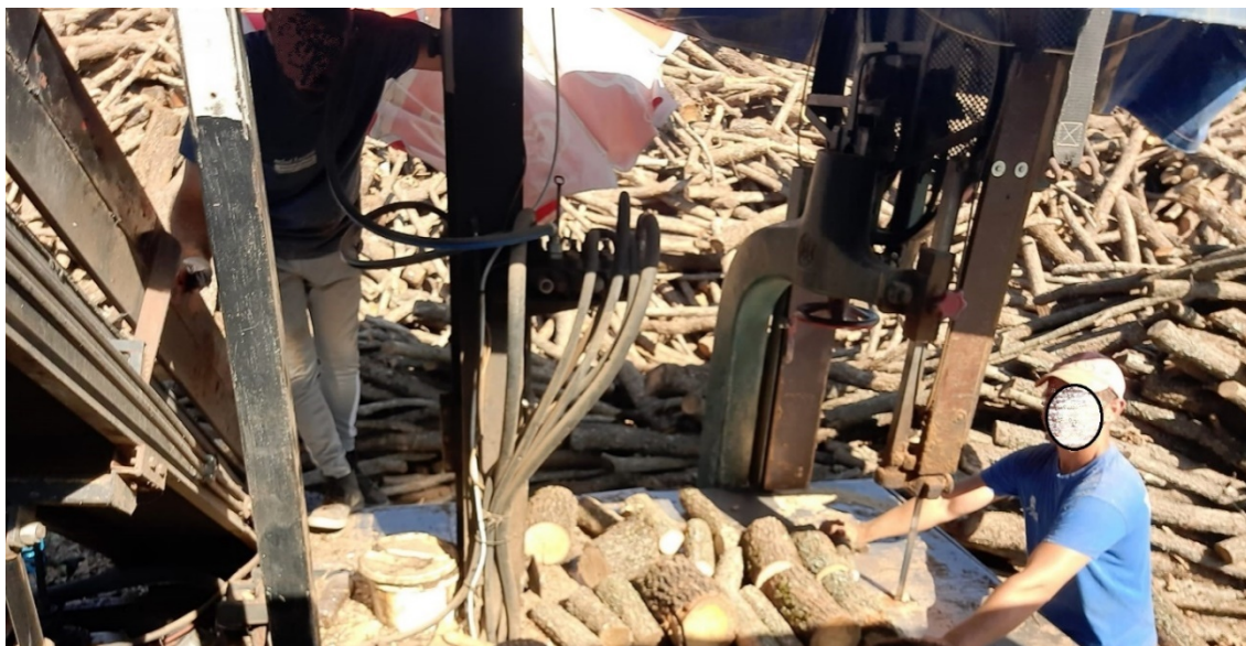
Εικόνα 6.5: Τελική κοπή καυσόξυλων σε μικρά τεμάχια έτοιμα για καύση σε πριονοκορδέλα.
