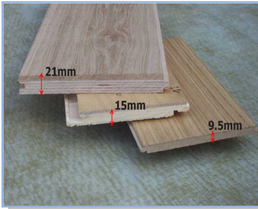
Εικόνα 3.8: Πολύστρωμες σανίδες ξύλου (τρικολλητά δάπεδα)
