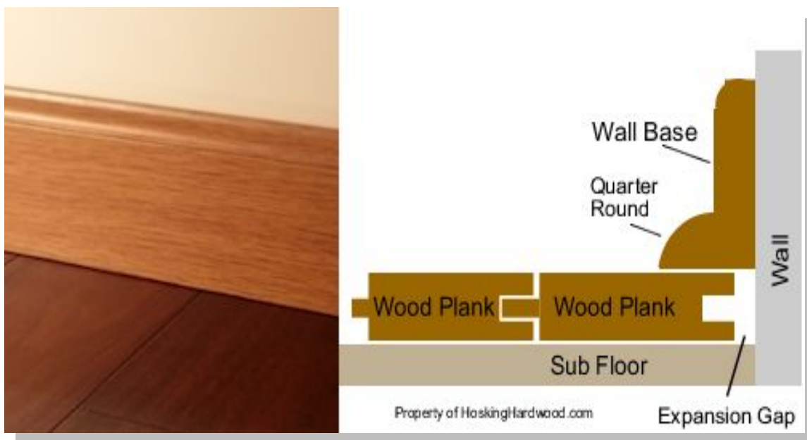
Εικόνα 3.32: Γείσο περιμετρικά των τοίχων
