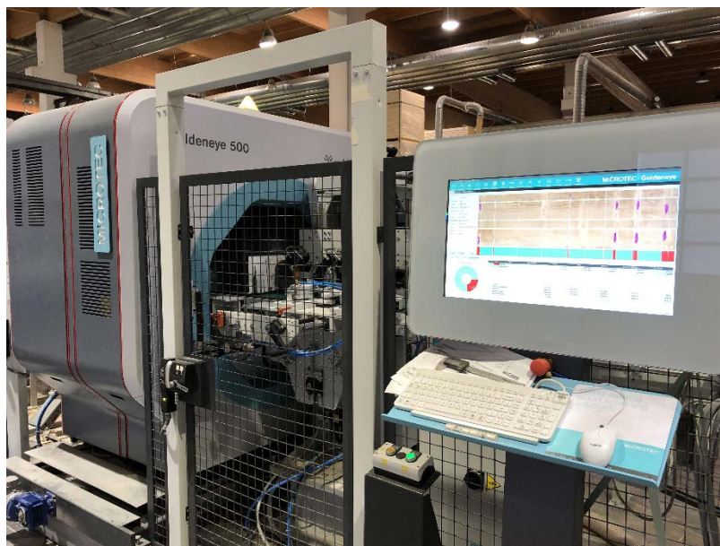
Εικόνα 6.21: : Απεικόνιση σφαλμάτων και σχεδίου κοπής στην οθόνη του μηχανήματος.
