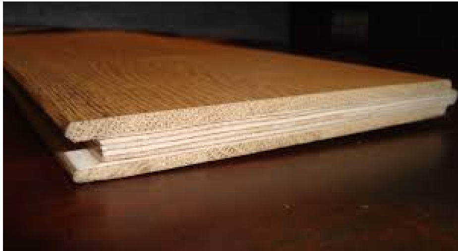
Εικόνα 4.3: Τρικολλητό δάπεδο με μεσαία στρώση κόντρα πλακέ
