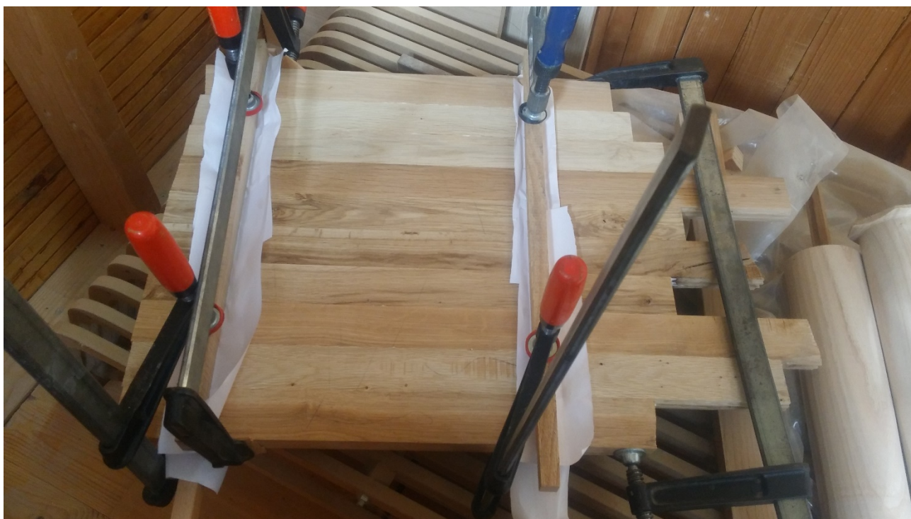
Εικόνα 6.14: Διαδικασία κατά πλάτους συγκόλλησης των ξυλοτεμαχίων για την παραγωγή του καθίσματος.
