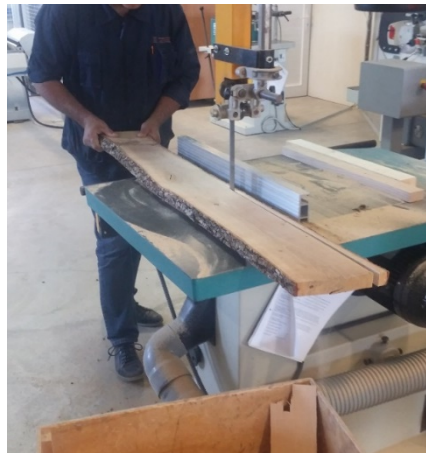
Εικόνα 6.10: Ο κ. Γεράσιμος Μπόθος κατά τη διάρκεια της παρύφωσης των δοκιμίων στην πριονοκορδέλα του τμήματος.
